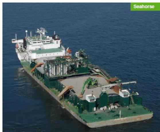
Figura 5-2 Embarcación Seahorse para colación de la banqueta
