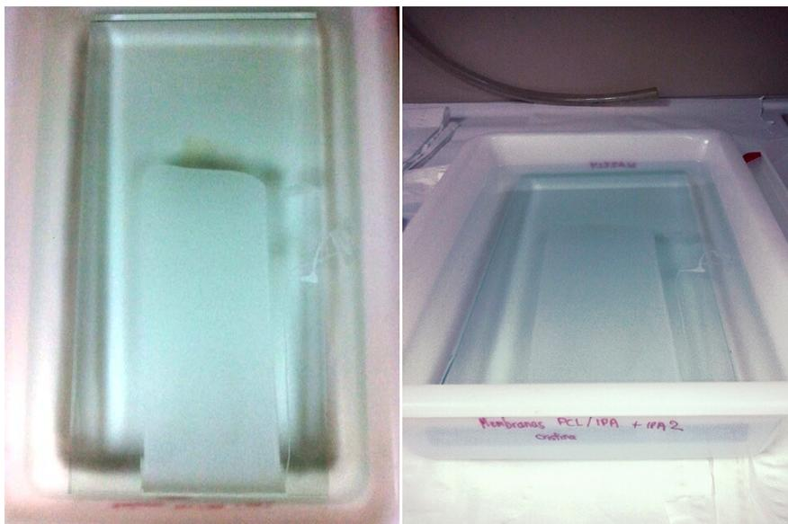
**Figura 2.4 Membrana de PCL durante su precipitación dentro del primer baño de coagulación.**
