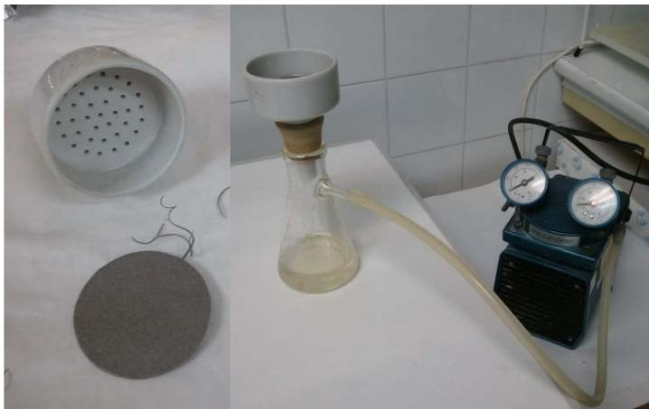
**Figura 2.2 Filtro de malla metálica, kitsato y bomba de vacío.**
