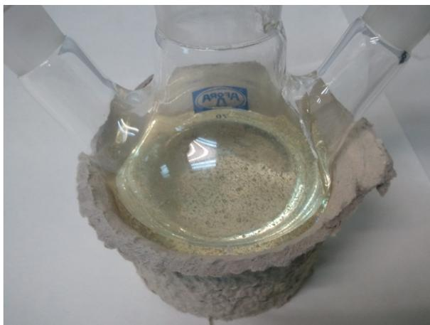
**Figura 2.3 Disolución de PCL al 15% w/w en NMP ya filtrada y lista para desgasificar.**
