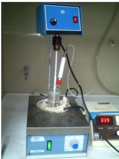
**Figura 2.1 Sistema experimental empleado para la preparación de la disolución de PCL al 15% w/w en NMP (agitador, manta calefactora y termopar).**
