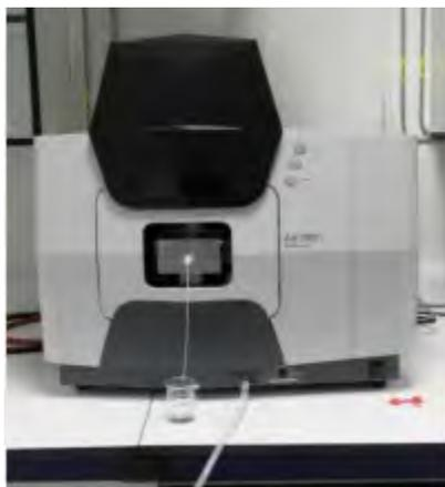
Figura 2.6. Equipo de adsorción Shimadzu AA7000
