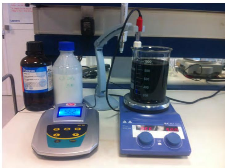
Figura 2.4. Equipo experimental para la neutralización del SSL
