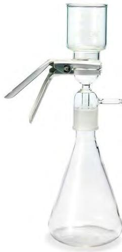
Figura 2.2. Equipo de filtración
