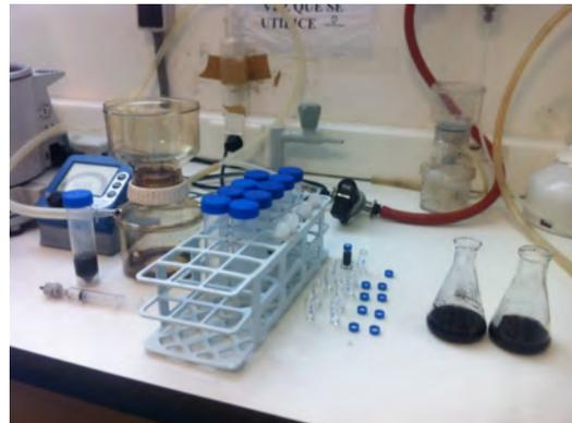
Figura 2.6. Equipo experimental utilizado en los ensayos con carbón activo. A la izquierda imagen del agitador orbital y a la derecha equipo de filtración
