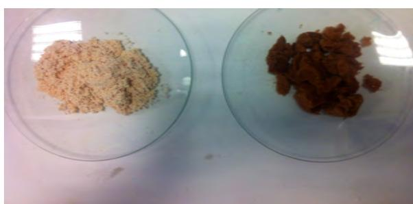
Figura 2.1. Resinas: A la izquierda la resina aniónica Amberlite® y a la derecha la resina catiónica Dowex®
