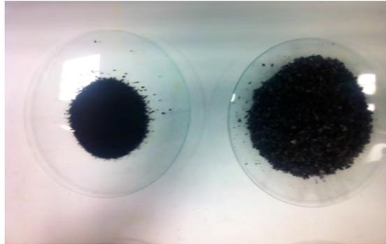
Figura 2.5. Adsorbentes: A la izquierda negro de humo en polvo y a la derecha carbón activo granular
