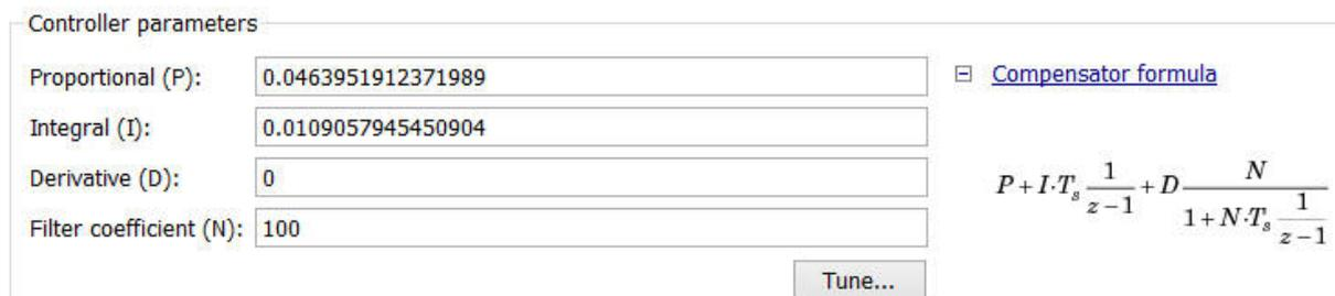
Fig 4.15 – Parámetros del PID.
