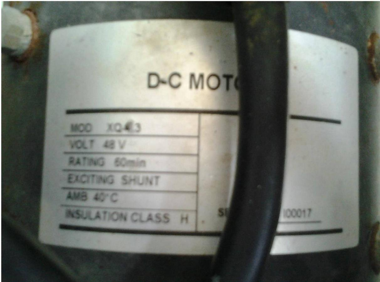
*Fig 6.6 – Fotografía del motor eléctrico del vehículo.*
