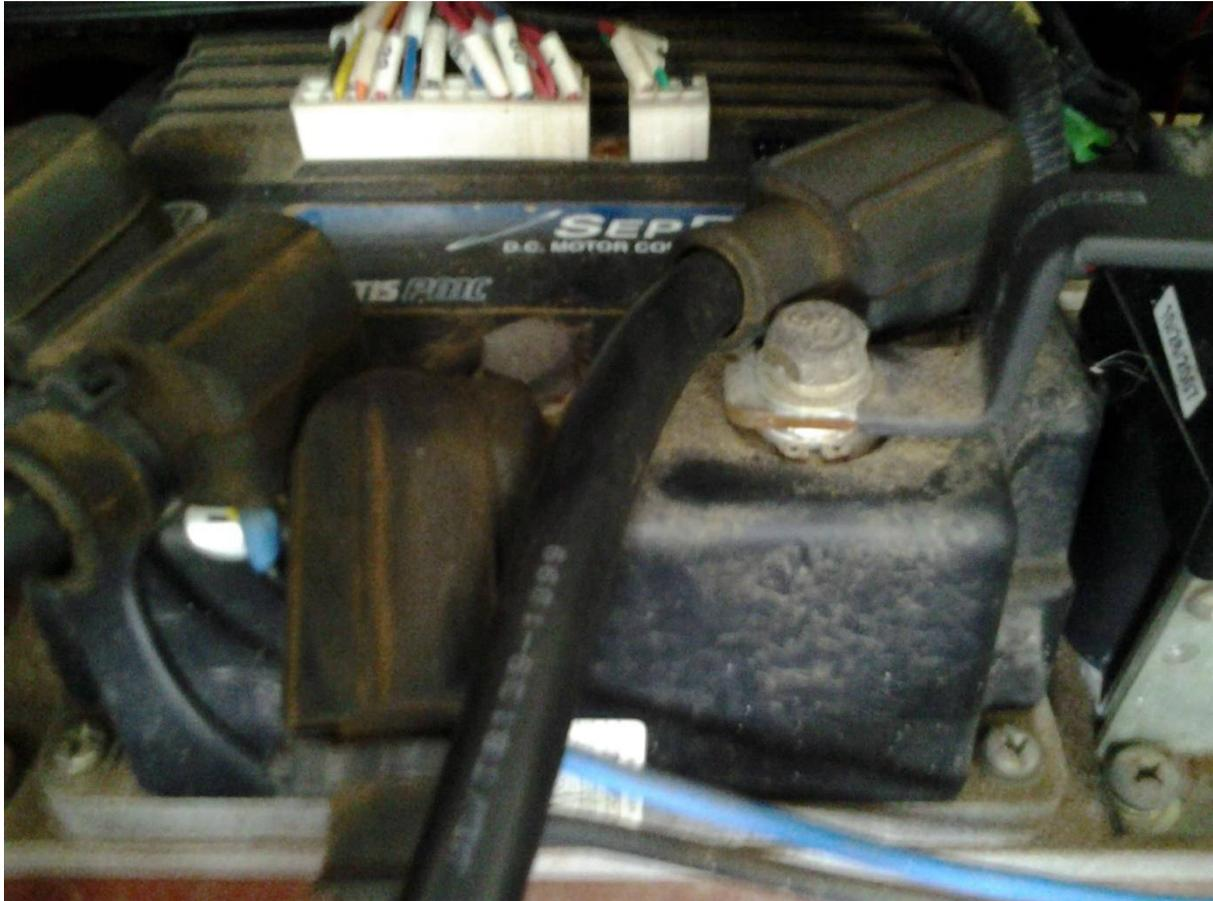
*Fig 6.2 – Fotografía de la controladora en el vehículo.*
