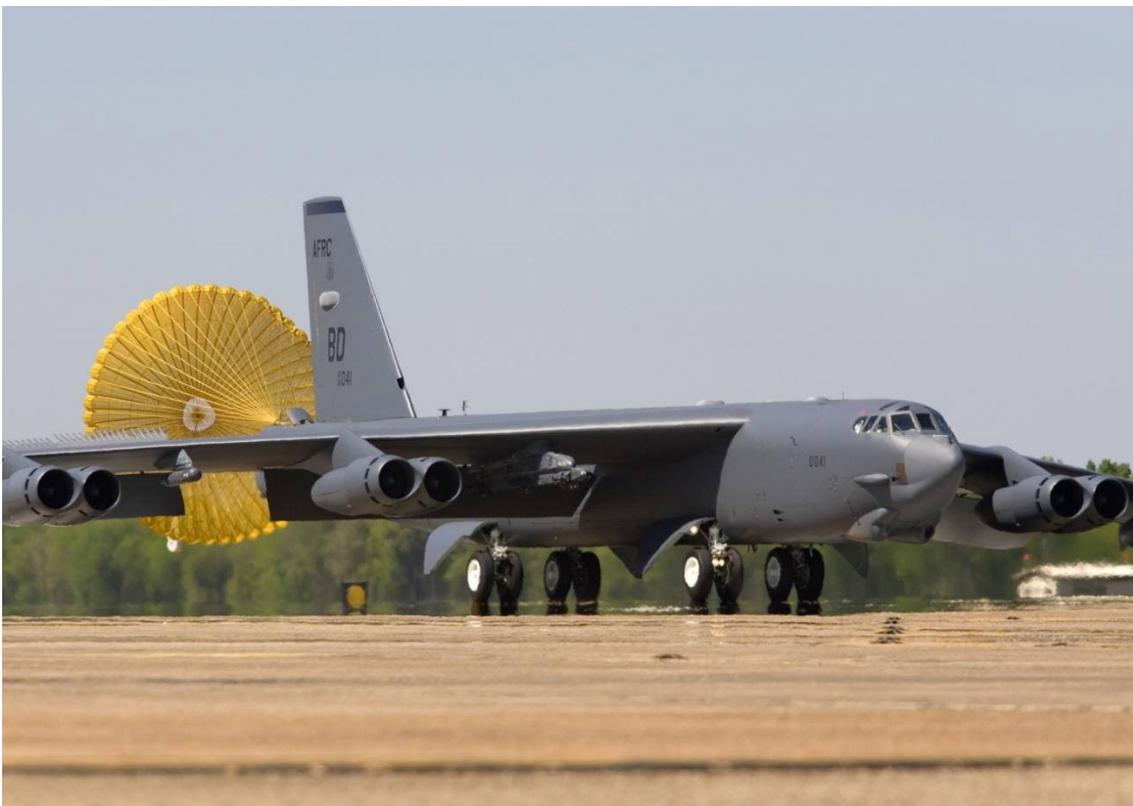
*Fig 5.1 – Avión con sistema de frenado con paracaídas.*
