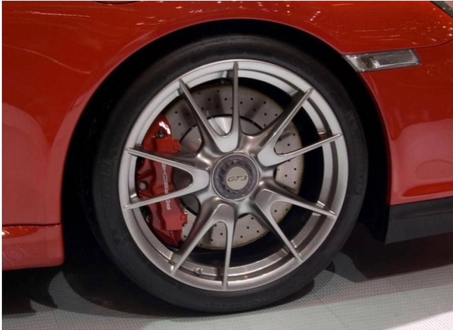
Fig 5.4 – Fotografía de unos frenos de disco.
