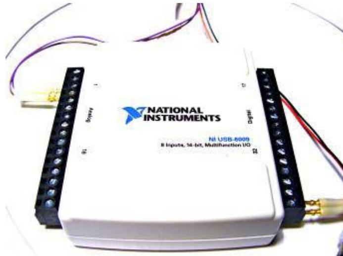
*Fig 6.12– Tarjeta de adquisición de datos NI USB-6009.*
