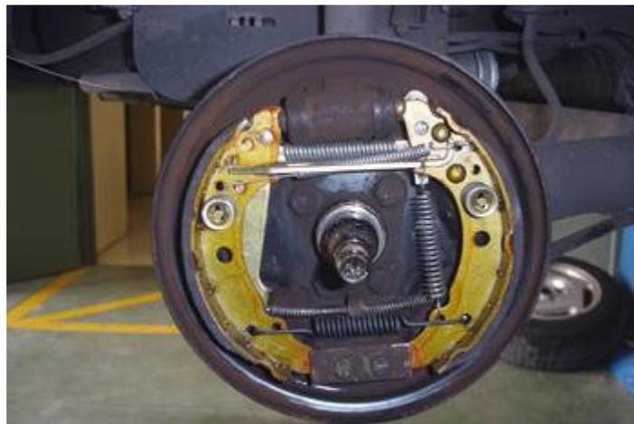
*Fig 5.6 – Fotografía del interior de un freno de tambor.*
