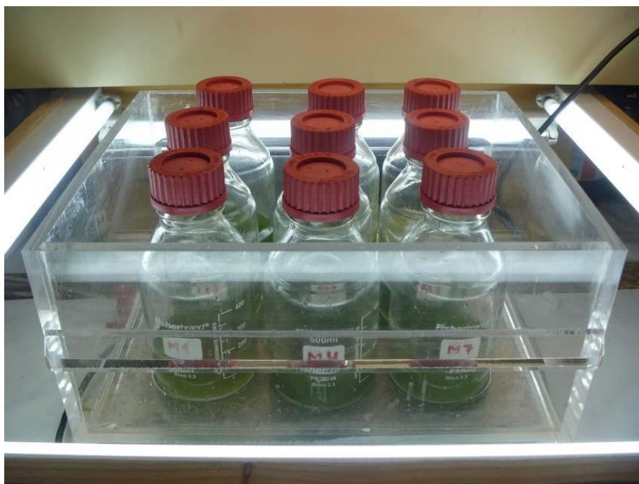
**Figura 6.4:** Muestras del ensayo en el fotobiorreactor
