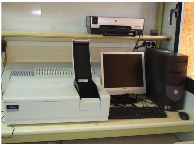
**Figura 5.6:** *espectrofotómetro Perkin Elmer Lambda 25*
