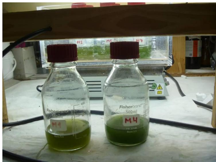
**Figura 5.3:** Reactores batch con la muestra y el agitador magnético de fondo
