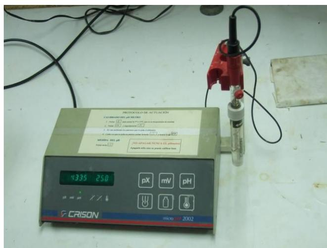
Figura 5.4: *microPH 2002 CRISON y electrodo pH INGOLD*
