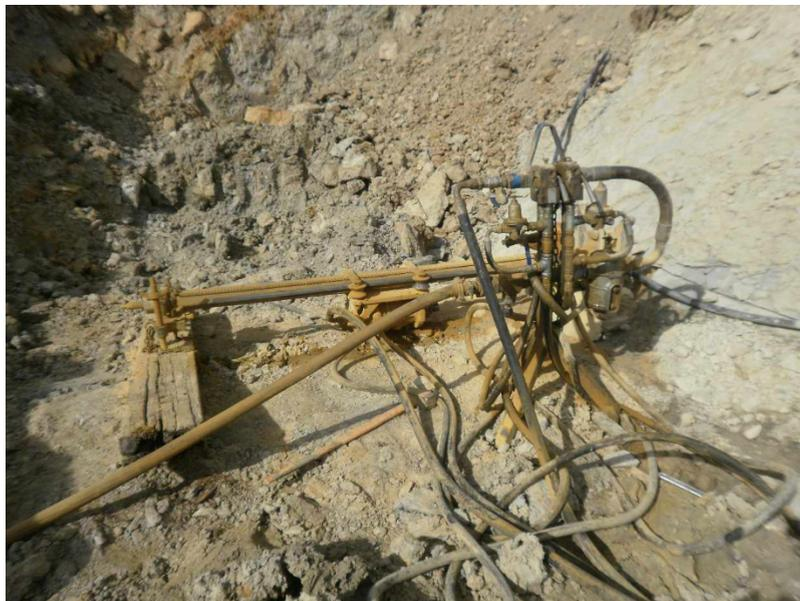
Imagen 12. Perforadora de barrenos.
