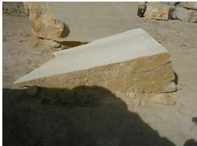
Imagen 19. Cuña de caliza debido a cortes horizontales paralelos al suelo.
