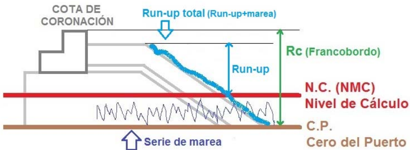
Figura 4.1. Esquema dique talud
