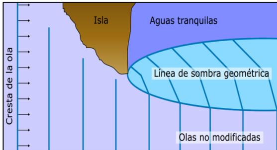
Ilustración 10 - Fenómeno de difracción (11)
