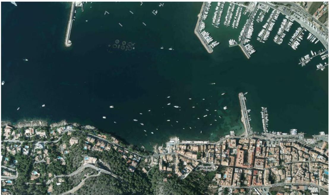
El puerto consta básicamente de dos dársenas, una al abrigo del dique exterior y otra interior, definida por el dique de abrigo de las instalaciones del Club de Vela y por el antiguo dique interior, compuesta de dos partes, la de Levante ocupada por las instalaciones de gestión directa de la Administración.
