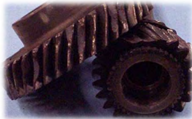
Figura 29. “Engranaje fuera de servicio con defecto de fatiga”
