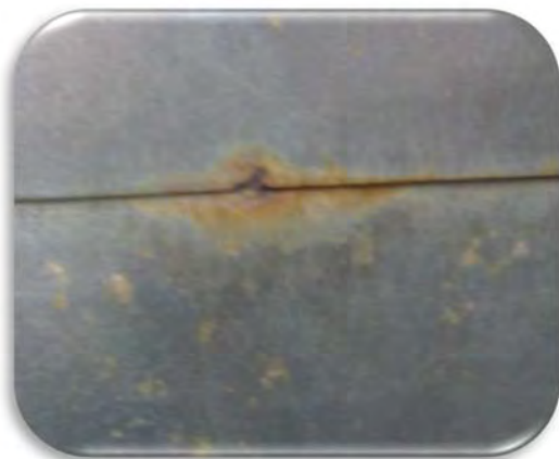
Figuras 22 y 23. “Ejemplos de zonas propensas a corrosión en resquicios”
