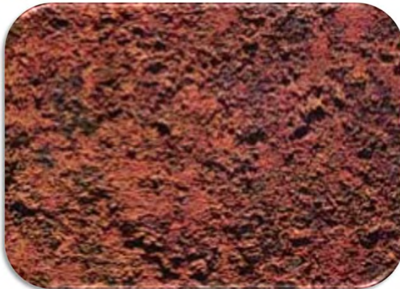
Figura 12. “Pieza de hierro con corrosión generalizada”
