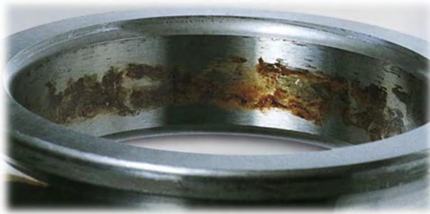
Figura 34. “Ejemplo de corrosión por fricción”
