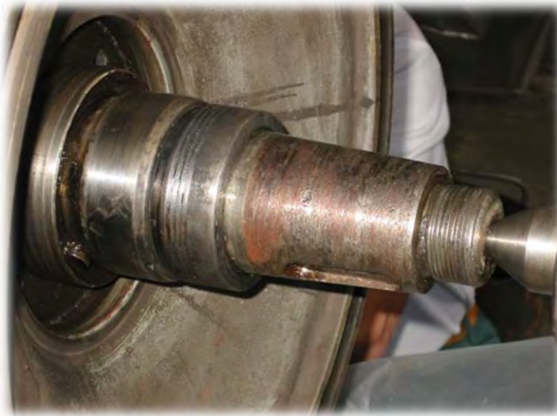
Figura 35. “Corrosión por fricción experimentada en un eje”
