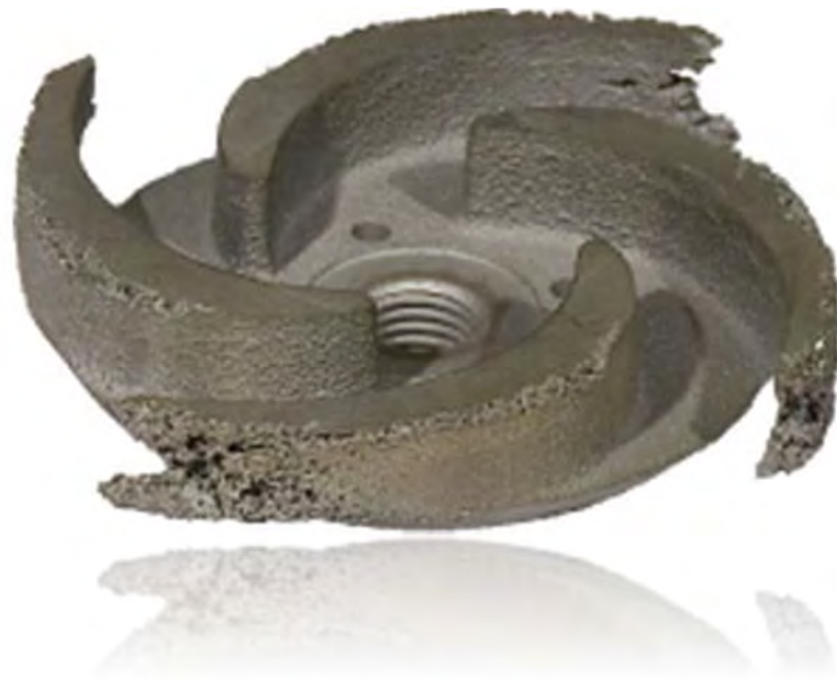
Figura 37. “Corrosión por cavitación experimentado por una hélice”
