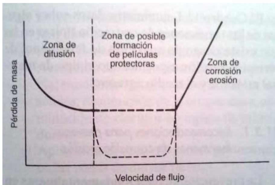
Figura 32. ” Relación entre pérdida de masa y velocidad de flujo cuando el fluido transporta sólidos en suspensión”
