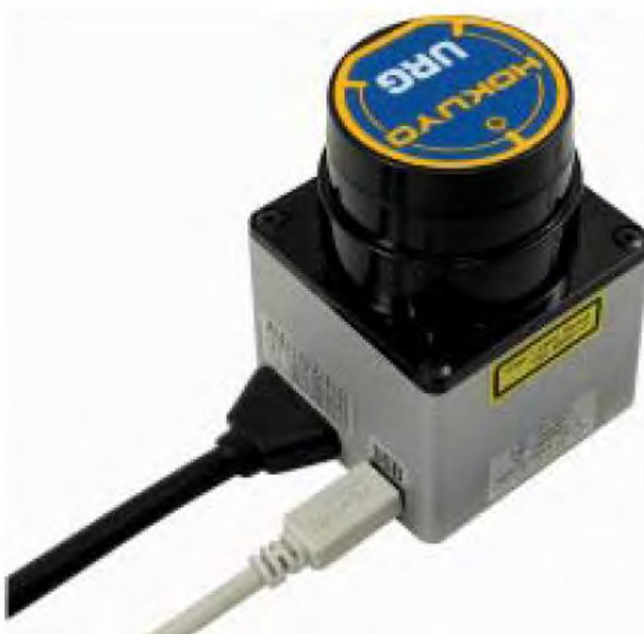
(figura 30) laser de rango HOKUYO URG-04LX. Fuente: Robosoft, documentación técnica RobuLAB10.
