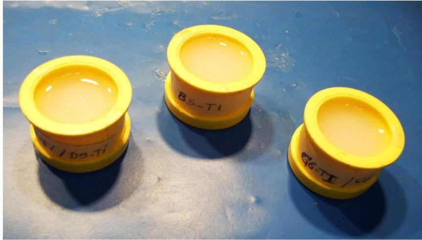
Figura 12 - Inmersi3n de las cabezas de los f3mures en las resinas
