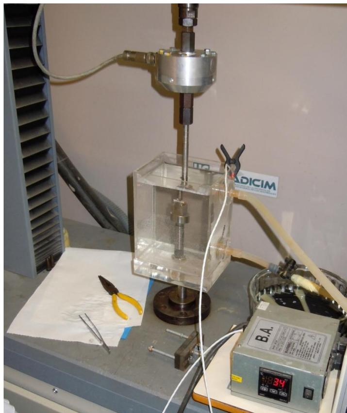
Figura 9 - Instalaci3n empleada en la realizaci3n del ensayo de flexi3n en cuatro puntos
