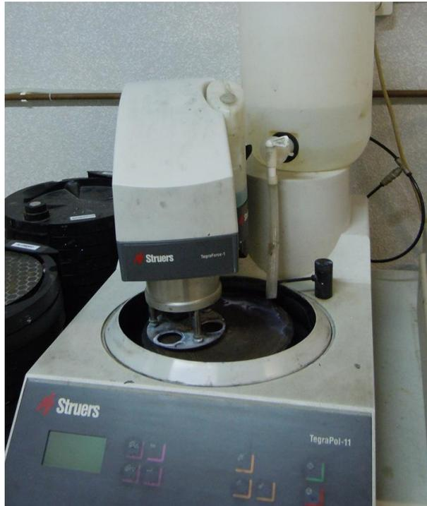
Figura 13 - Pulidora de muestras embutidas
