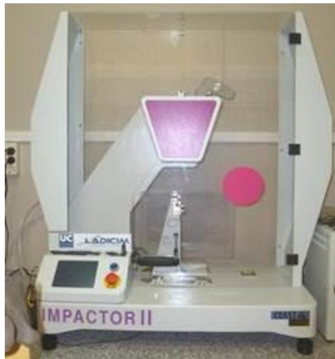
Figura 20 - M3quina para la realizaci3n de ensayos de impacto
