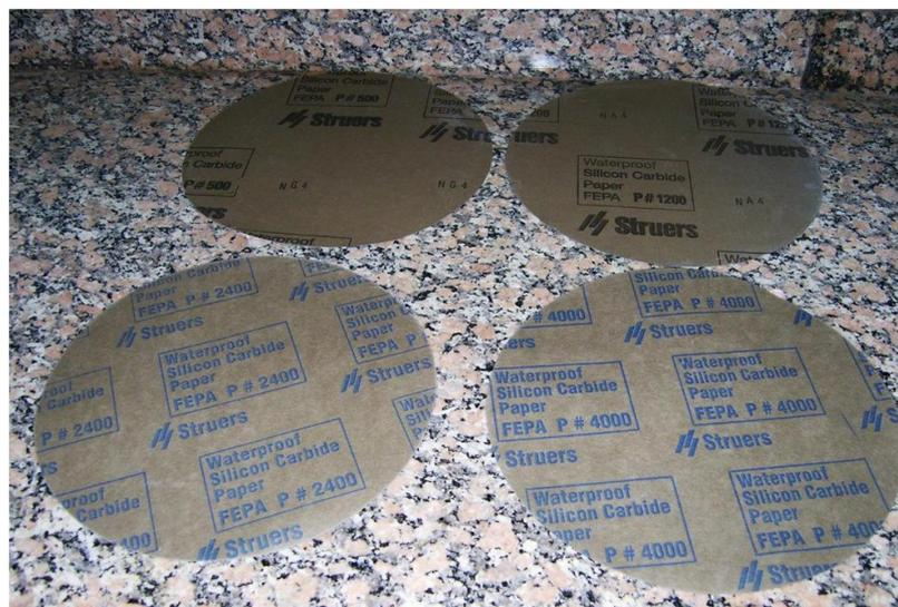
Figura 14 - Muestras de algunos de los discos de carbonato de silicio empleados
