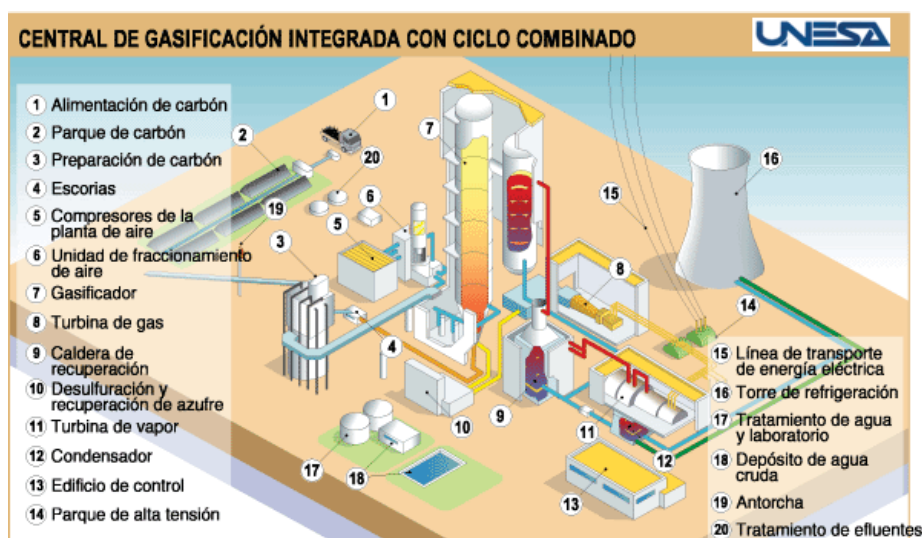
Figura A.55 - Funcionamiento central de gas de ciclo combinado
