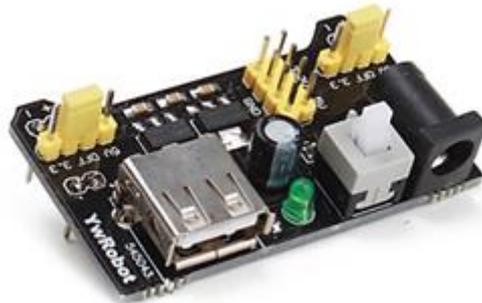
**Figura 22.** Detalle regulador de tensión doble
