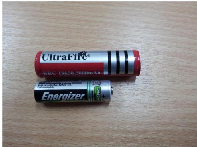
**Figura 19.** Comparativa entre batería 18650 y pila alcalina AA.
