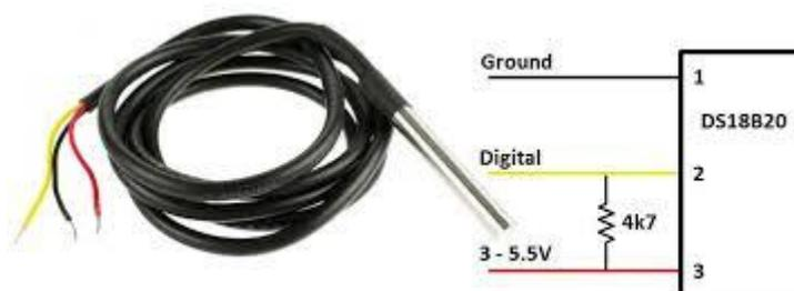
Figura 13. Detalle del diagrama de conexión del sensor DS18B20.
