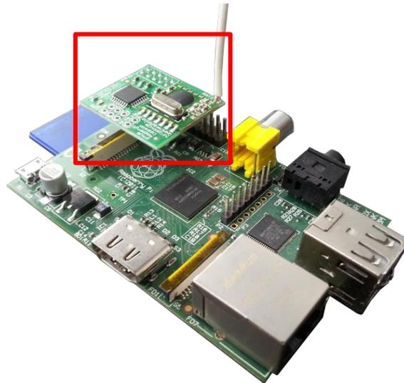
**Figura 8.** Instalación del módulo en la RPi.
