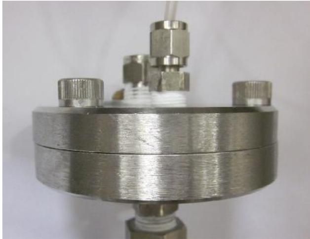
**Figura 2.17.** *Celda de permeación.*
