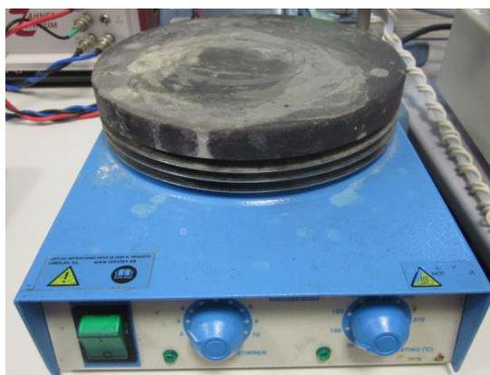
**Figura 2.9.** *Placa calefactora.*
