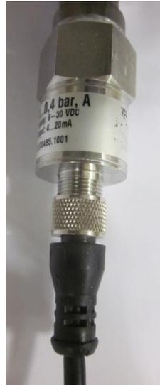
**Figura 2.15.** *Transductor de presión de la cámara de permeado.*
