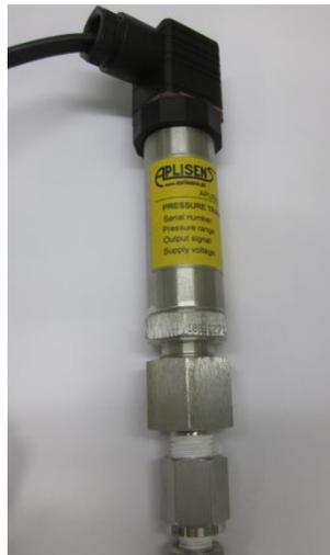
**Figura 2.14.** Transductor de presión de la cámara superior.
