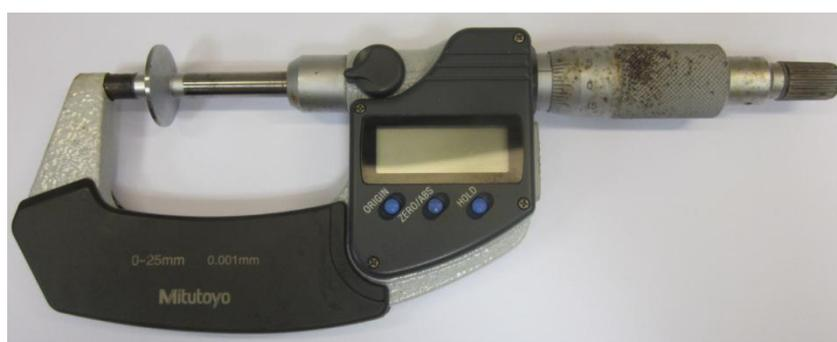
**Figura 2.20.** *Micrómetro.*
