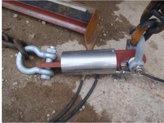
**Figura 2.12:** Células de carga de las líneas de fondeo
