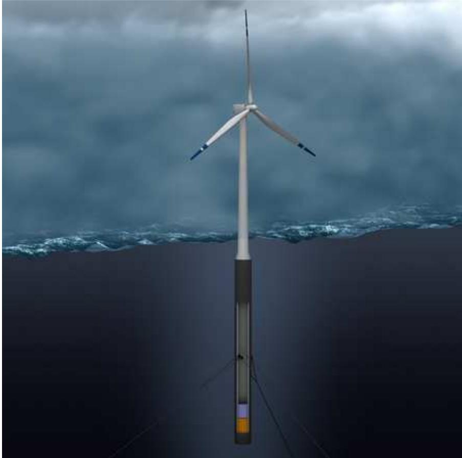
**Figura 1.7:** Aerogenerador flotante marino tipo *Spar* (Fuente: *Statoil*)
