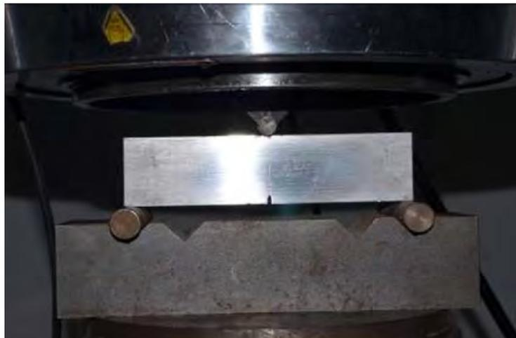
**Figura 28: Utillaje acoplado a la máquina Instron de ensayos.**
