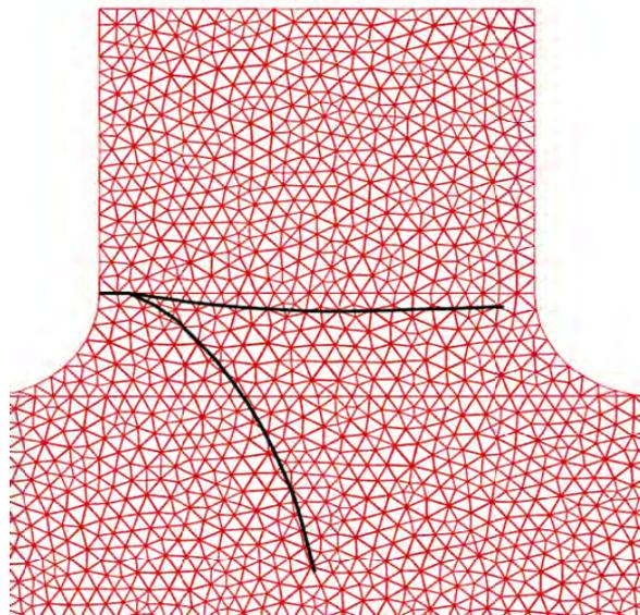
**Figura 7: Zoom de los caminos de la propagación de la grieta (líneas negras). Placa gruesa (grieta superior) y placa fina (grieta inferior) (Sumi, Yang, & Wang, 1985)**
