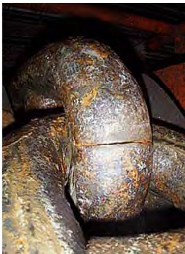
**Figura 5: Fisura en un eslabón con concreto de un sistema de fondeo de un carguero.**
