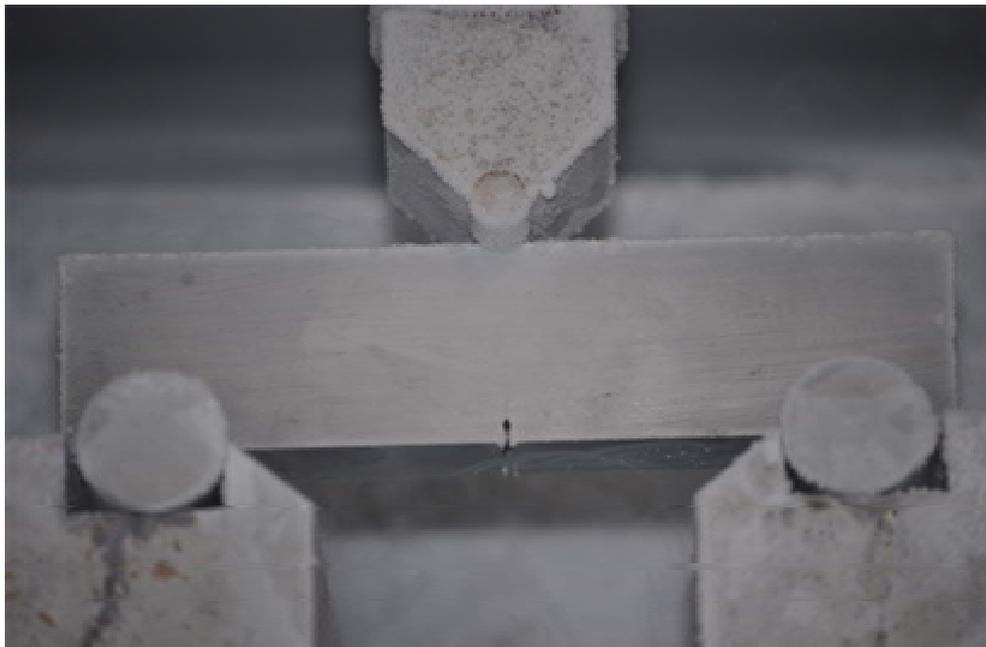
**Figura 78: Detalle de la probeta sobre la máquina de ensayos.**
