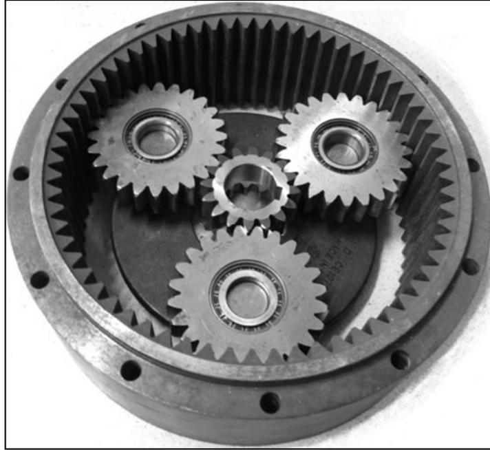
*Figura 1. Montaje de componentes de una transmisión planetaria*
