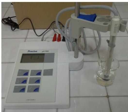
Figura 13. Medidor de pH Precisa pH 900
