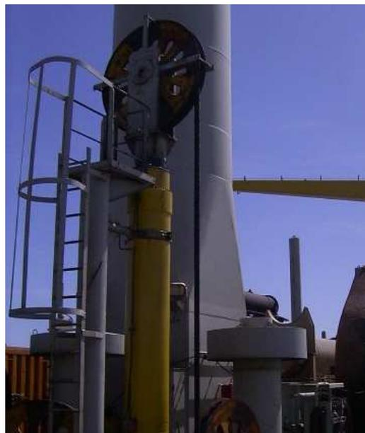
El cilindro consta de un máximo de capacidad de aceite de 377lts con una carrera de 3000 mm y un diámetro de biela de 400mm.
