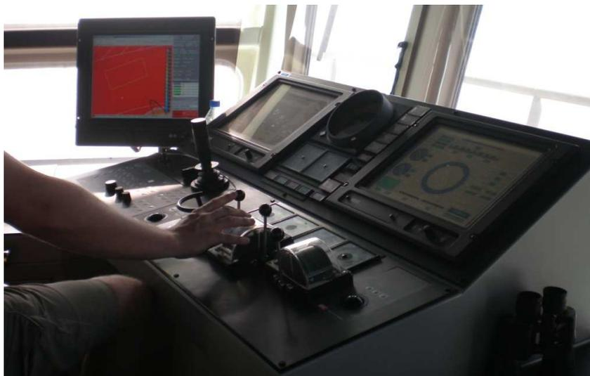
A partir de este momento, todo el proceso se monitorea desde el puente, tanto desde la consola de dragado como desde la consola de navegación teniendo el skiper como función principal la de mantener el buque a rumbo para que el cabezal se deslice con gran precisión sobre las tracas de dragado, mientras el operador de dragado se encargará de maximizar la producción.
