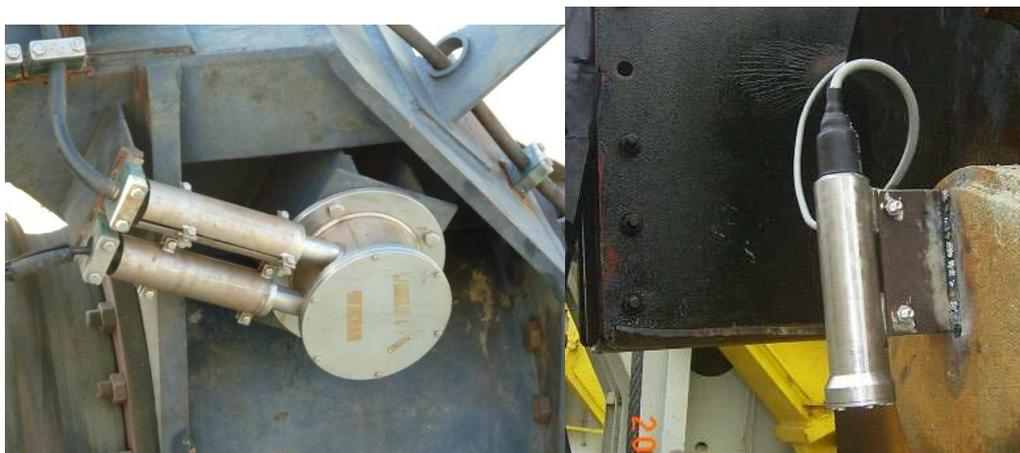
Dicho sistema se basa en una serie de sensores electro-mecánicos (verticales y horizontales) integrados con el sistema IMC, fijados a partes específicas del tubo de succión proporcionando la posición exacta con un margen de error muy bajo una vez el sistema ha sido calibrado.
