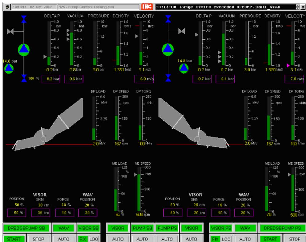
El sistema hidráulico del cabezal activo, el visor y las flaps son operados y monitoreados por el sistema IMC desde la consola de dragado situada en la parte posterior del puente.
