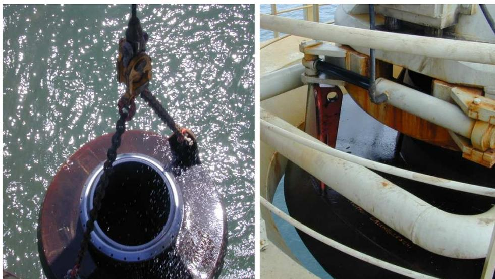
Una vez finalizado el acople y seleccionada la conexión de proa como punto pivote en el sistema DP, se selecciona el modo DP Auto para evitar tensiones que pudiesen partir la línea conectada a tierra durante la descarga
