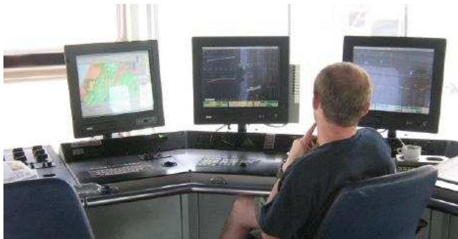
En este momento todo está preparado para iniciar la operativa de dragado, llegado el momento en el cual se entra en zona, se arria el pescante del cabezal hasta ver entrar en funcionamiento el compensador de oleaje indicativo de que el cabezal ha tocado fondo y se aumentan las rpm de la bomba por encima de 200rpm. en función del material a dragar.
