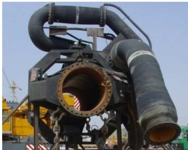
Las pinzas de acero van unidas al sistema cardan mediante dos pines de acero ST50 con sus respectivos sensores, permitiendo libertad de movimiento del tubo en el plano horizontal. Las defensas del tipo Omega, de alta compresión con una energía de absorción de 60KN a una fuerza de 350 KN/m, están distribuidas a lo largo de la parte interior y superior con el propósito de proteger no solo la estructura principal, sino también la línea de agua a presión.
