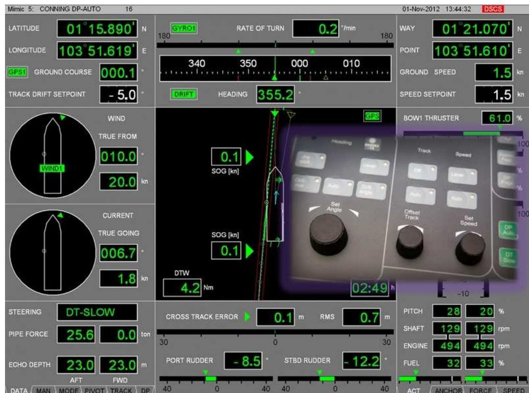
Se selecciona el sistema de posicionamiento dinámico para controlar el rumbo, velocidad y posición por el operador. Las correcciones por viento, corriente, dirección, giro y velocidad de giro son calculadas automáticamente por el sistema.
