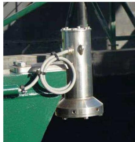
Miden la altura de la superficie de agua sobre la tolva, calculando el volumen en m3
