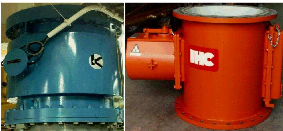
Formado por un microprocesador acoplado a una sección de tubo GM (Greiger-Muller) compuesto de celdillas cerámicas con un grosor de 28mm sobre las que se aplica un sistema de medición radioactivo Co 60 (Actividad 8,51 GBq)
