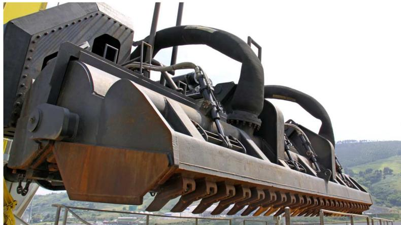
En la parte del cabezal contigua al casco, va instalada una defensa para proteger de una vía de agua y la unidad hidráulica en caso de colisión especialmente en zonas poco profundas y consiguiente bajo resguardo bajo quilla
