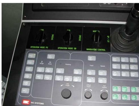
Una vez próximos a la zona de dragado, a una distancia aproximada de una eslora, se reduce la velocidad hasta 3 nudos (1,5 m / s), dependiendo de la dureza del material, el operador de dragado pone en marcha la bomba sumergible junto al sistema de chorro al mismo tiempo que se arrían los pescantes del cabezal e intermedio hasta una profundidad 4 ó 5 metros por encima de la cota de dragado.
