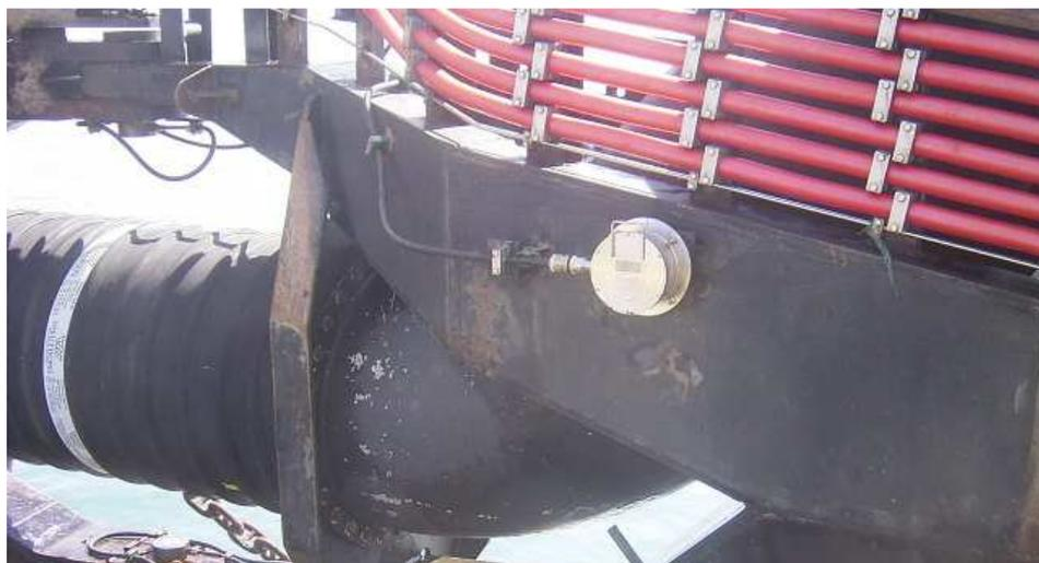
Estos ocho sensores junto a un sensor de profundidad situado en la parte interna del cabezal, proporcionan la información necesaria para realizar operaciones de dragado con un margen de error por debajo de un metro en proyectos de alta precisión (Ej. Cableado Submarino)
