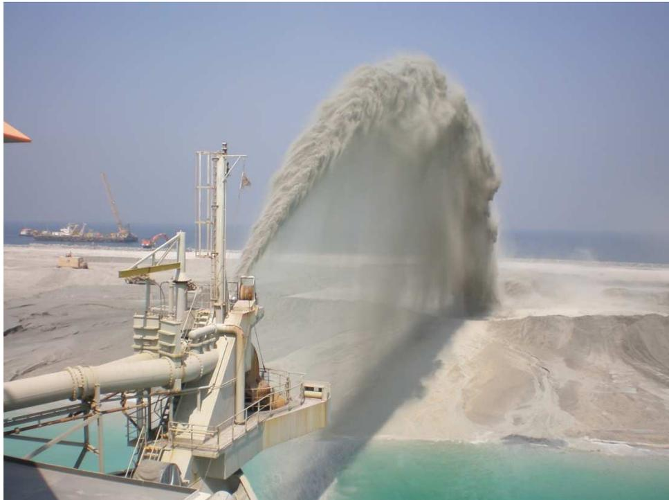
Al igual que en el proceso anterior, se selecciona el modo DP Auto con el objetivo de mantener la posición de la proa y compensar la fuerza de retroceso ejercida por la descarga del material.
