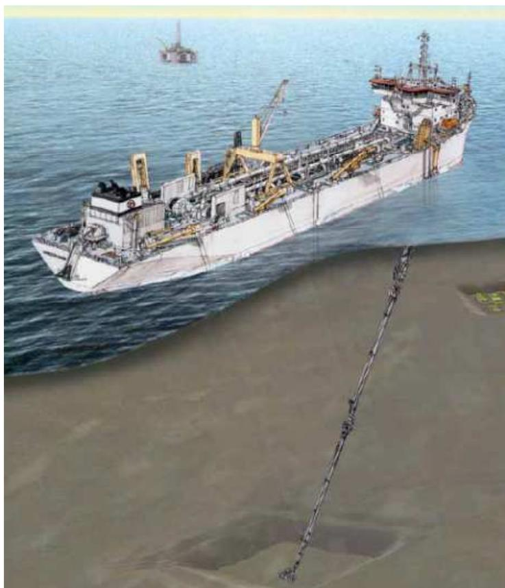
Dado la dureza del material a dragar (Hard coral rock) se utilizó una draga de succión por arrastre con un cabezal especial para roca en la zona de mayores profundidades y una draga tipo retroexcavadora en la zona de menores profundidades.
