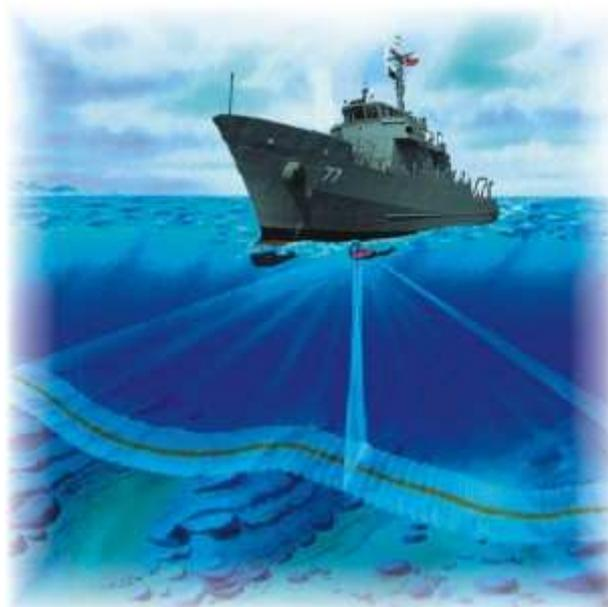
El funcionamiento de estos equipos es similar y se basan en el principio de pulsos acústicos de alta frecuencia. Las frecuencias normales de operación de la ecosonda y el sonar lateral son de 200 y 100 Khz.
