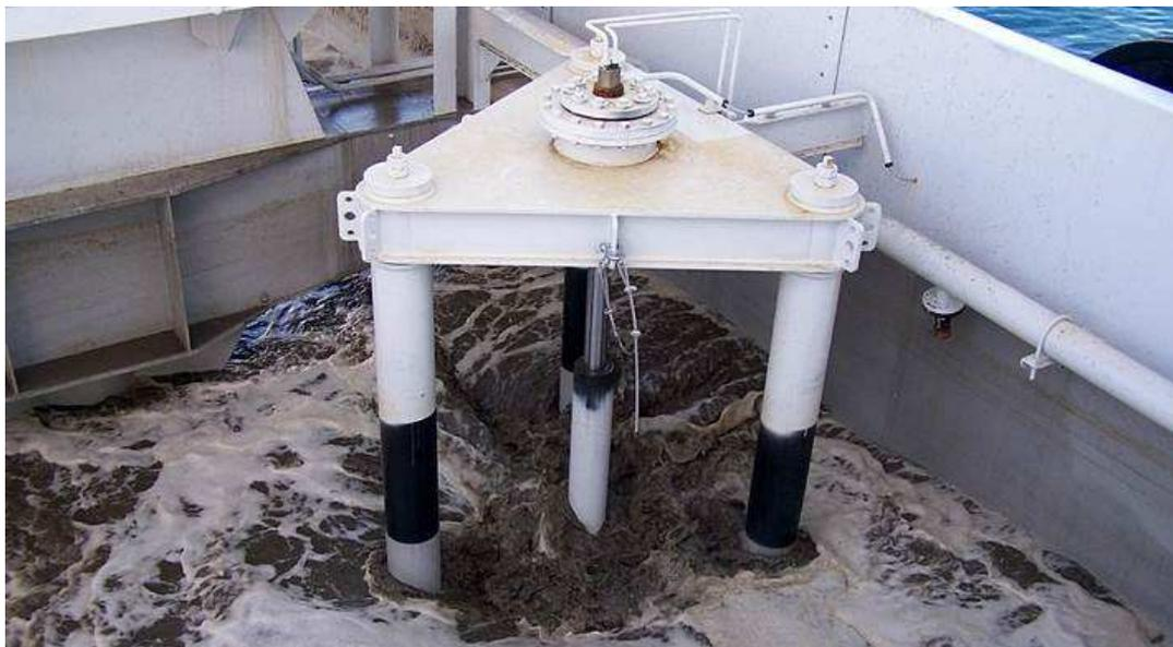
La altura de los reboses puede ser monitoreada automáticamente por el sistema IMC de forma que los calados máximos no sean superados durante el proceso de carga.
