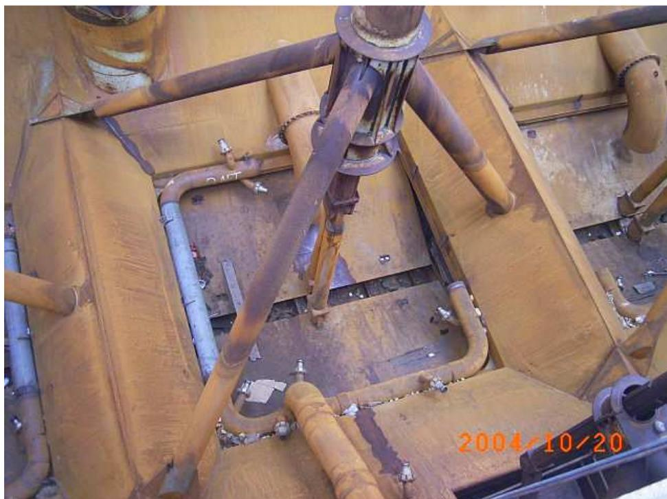
Cada compuerta doble está conectada a su cilindro correspondiente mediante dos vástagos de acero forjado a modo de bisagra, permitiendo la apertura hasta un máximo de 75° con respecto a la cubierta de fondo
