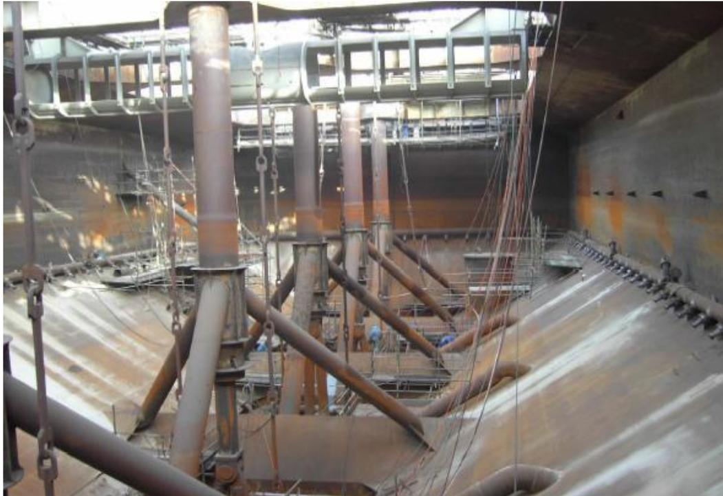
Lleva instaladas tres cajas de carga operadas desde la consola de dragado, accionadas hidráulicamente mediante sus respectivas válvulas.
