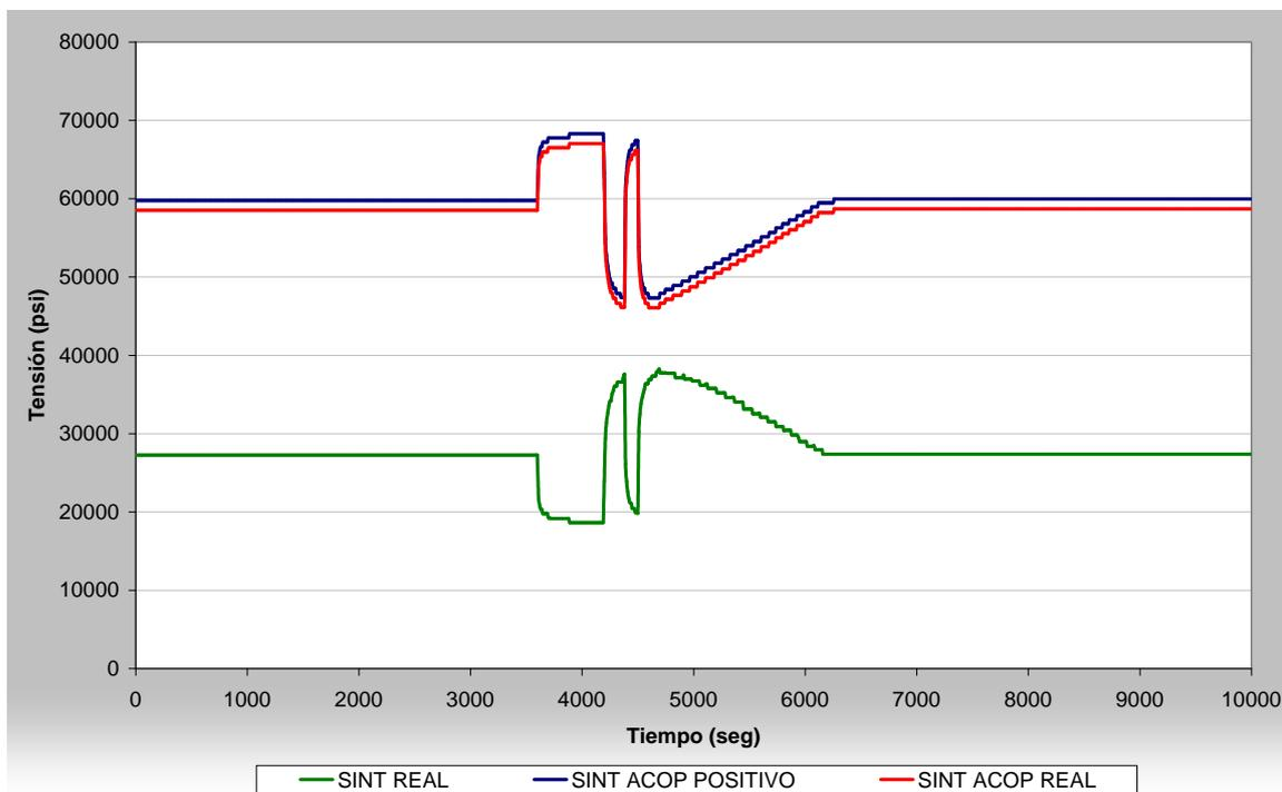
**Figura 6.78.** Tensión real frente a tensiones calculadas según acoplamiento tensional en el Blend radius (CLADDING) de la tobera de AA durante la Inyección de Refrigerante
