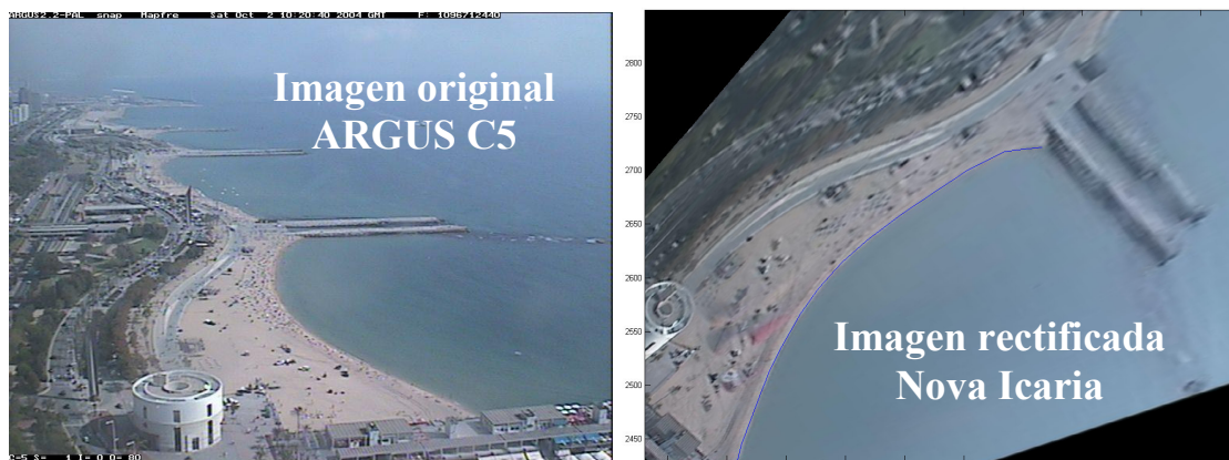
Figura 51. Imagen original (arriba) y rectificada de la playa de Nova Icaria, con línea de costa digitalizada (azul).
