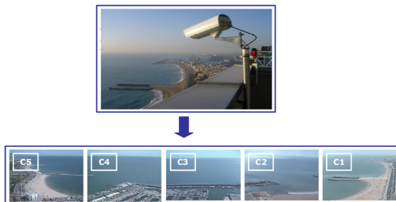
Figura 48. Video cámara del sistema ARGUS e imágenes instantáneas de su 5 video-cámaras.
