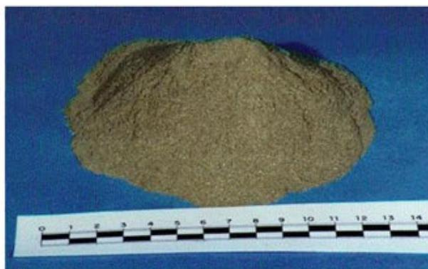
Figura 2-13. Cenizas volantes de incineración de RSU.
