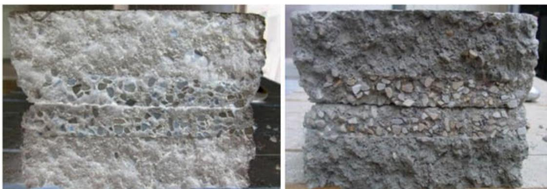
Figura 5-111. Sección de rotura ensayo dinámico G-152. Imagen normal y negativo.
