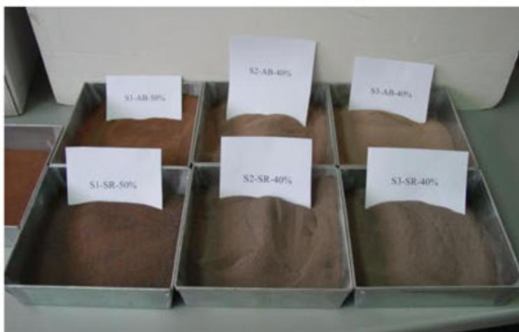
Figura 5-35. Muestras para ensayos de plasticidad.
