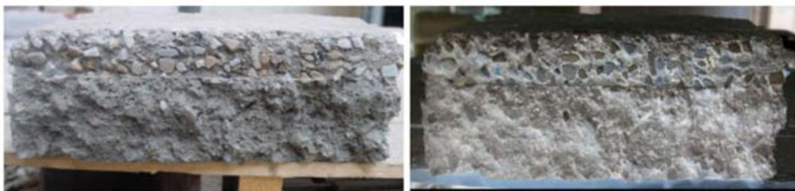
**Figura 5-116. Sección de rotura ensayo dinámico G-153. Imagen normal y negativo.**
