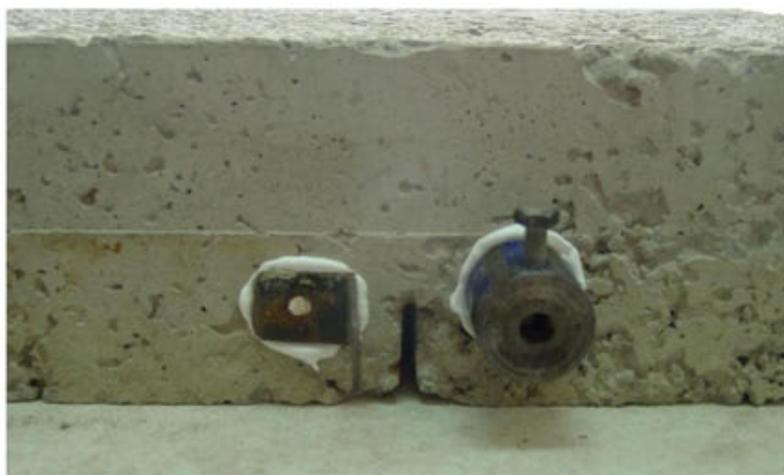
**Figura 3-19. Prefisura de 28 mm de profundidad**
