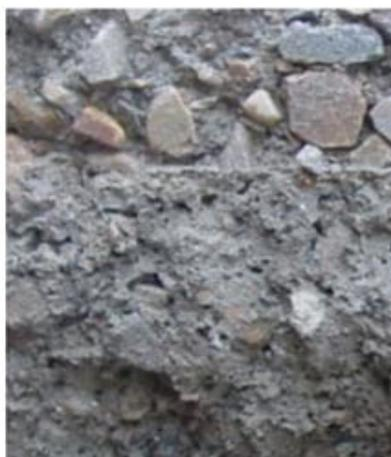
**Figura 5-117. Detalle de rotura ensayo dinámico G-153.**
