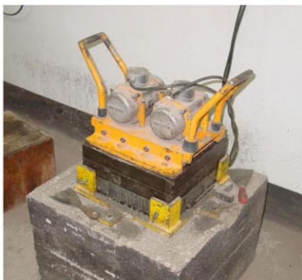
**Figura 3-16. Compactación de probeta**
