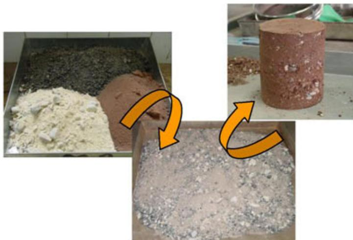
Figura 5-1. Detalle del proceso de fabricación de las mezclas con ceniza.
