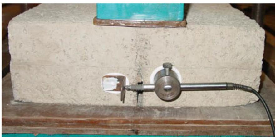
**Figura 3-20.Comparador LVDT empleado.**
