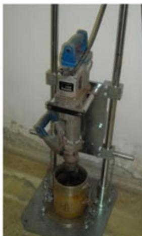
Figura 3-14. Compactación mediante martillo vibrante (NLT-310).
