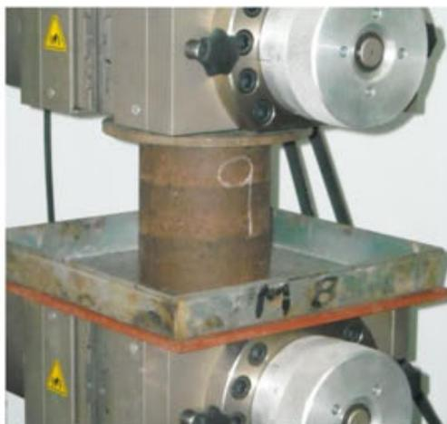
Figura 3-15. Ensayo de resistencia a compresión simple.
