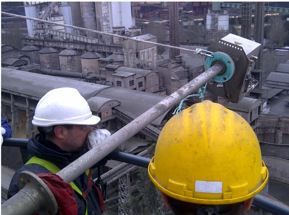
El extremo del tubo que se encuentra fuera de la chimenea va conectado a un filtro de partículas para evitar que la muestra de gases contenga polvo, lo cual podría dañar la parte óptica del analizador. Seguidamente nos encontramos con una cámara de acondicionamiento de muestra que se encarga de calentar la muestra a una temperatura de unos 180° para conseguir que ésta llegue completamente seca al analizador.
