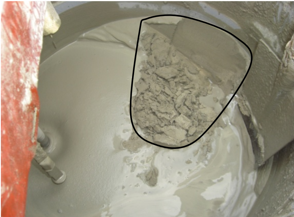
Fig. 67. Segregación experimentada para el relleno G 3 .
