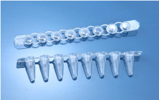
Figura 5. Tira de 8 tubos ópticos para PCR con tapas incluidas en los que está preparada la mezcla de reacción.
