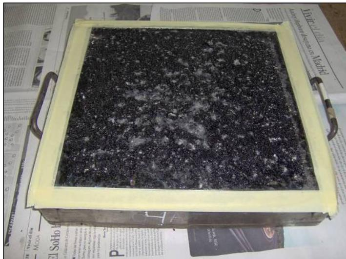
FOTO III-12 Colocación de papel adhesivo sobre el molde
