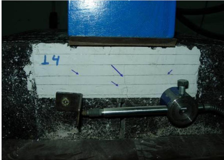
Figura 6.20 Grietas que se originan en un sistema con GM-1. Ciclo 10.000
