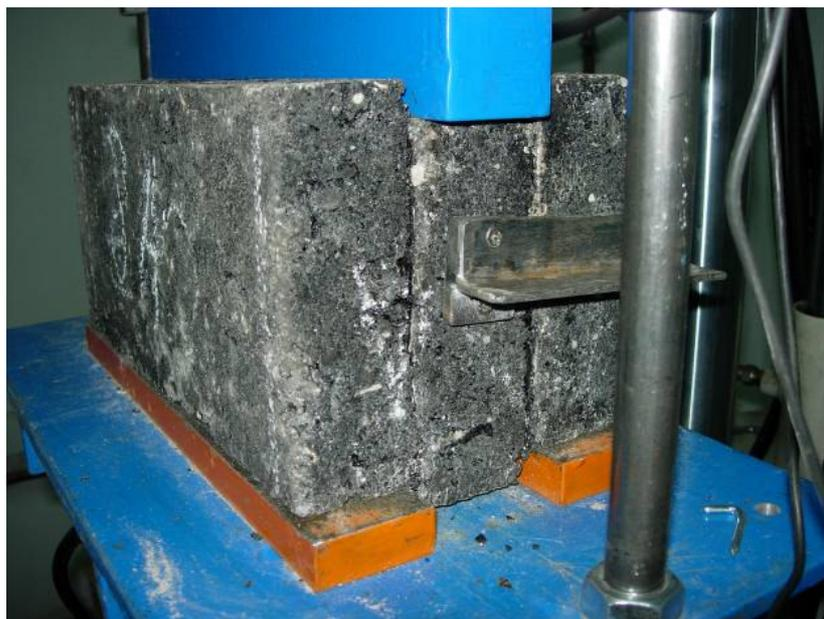
Figura 3.17 Momento de la rotura del ensayo de adherencia dinámico
