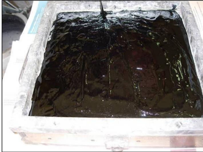
FOTO IV-18 Betún modificado sobre probeta
