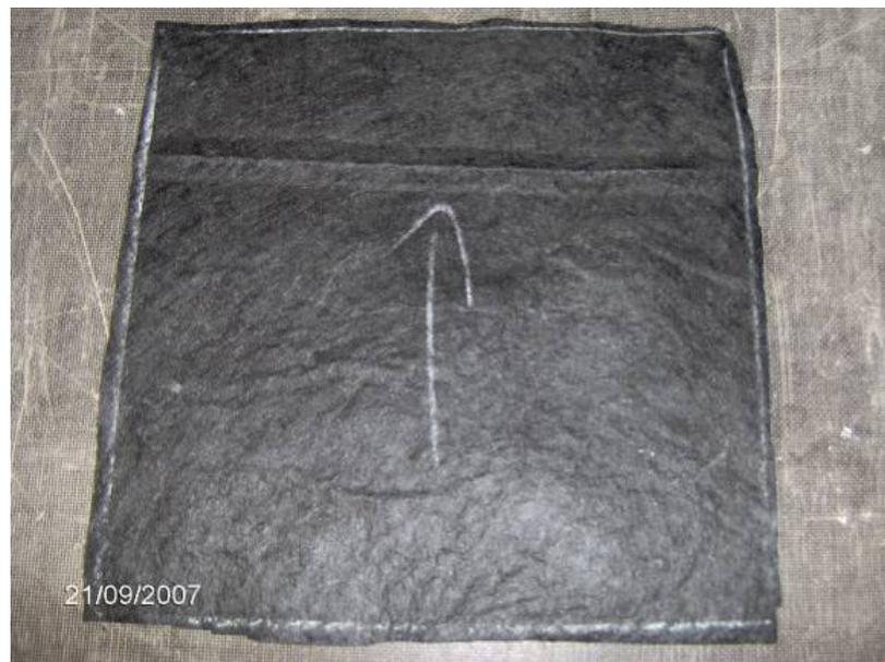
FOTO II-8 Geotextil de polipropileno (Amopave)
