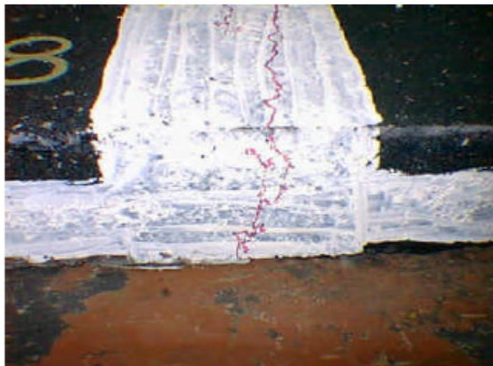
Figura 2.58 Localización de la grieta de falla en el ensayo ITT
