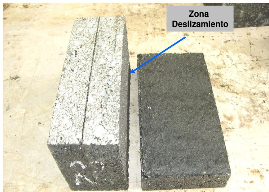
Figura 5.3 Deslizamiento del lado opuesto a la aplicación del betún residual
