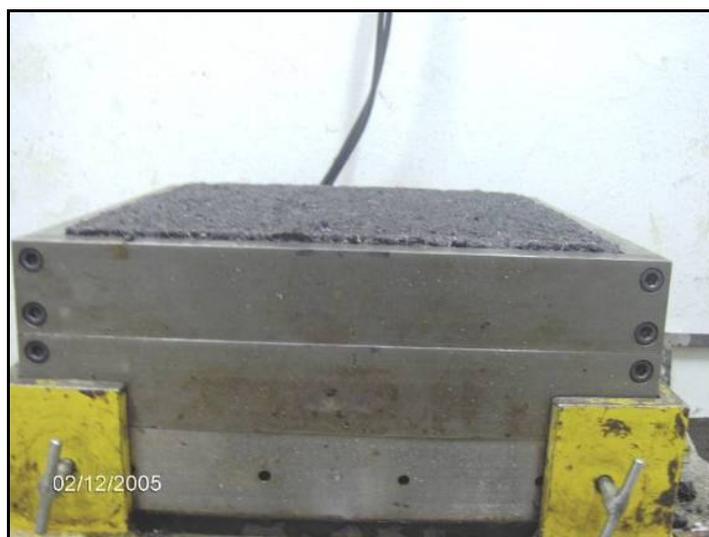
FOTO III-10 Molde de tres probetas de pista para ensayo de adherencia
