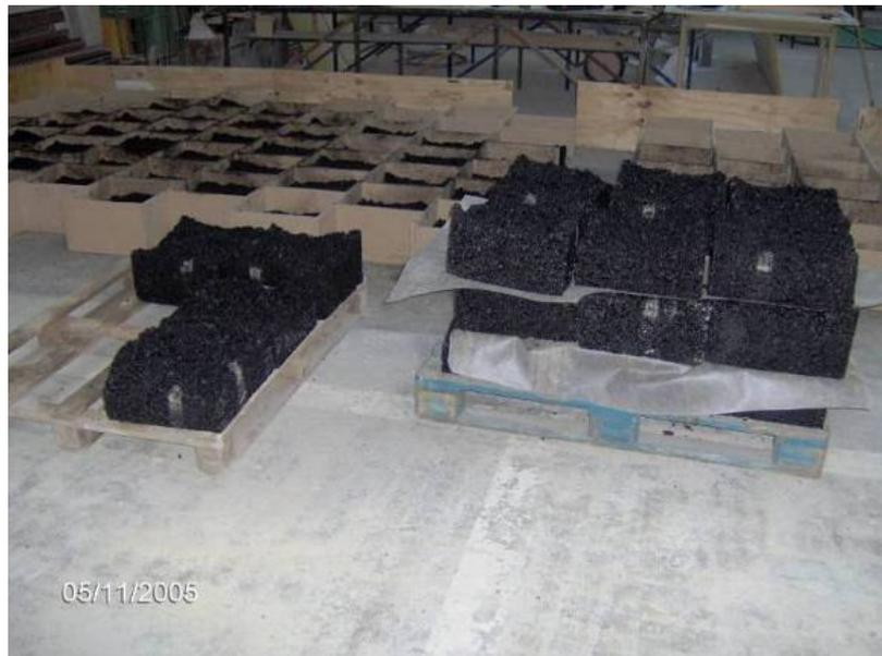
FOTO I-2 Desmolde de probetas
