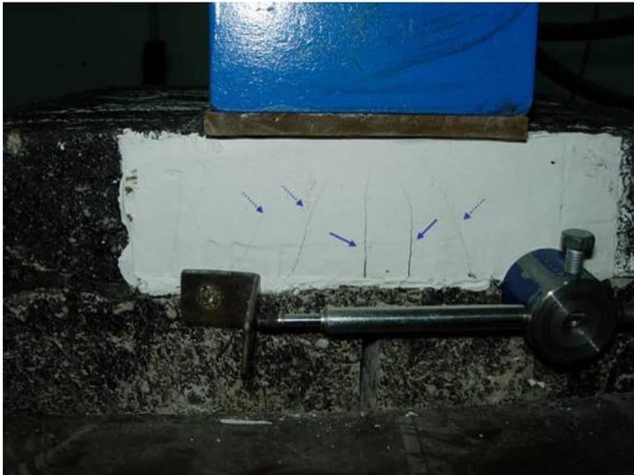
Figura 6.16 Grietas durante el ensayo dinámico geotextil Ciclo 35.000
