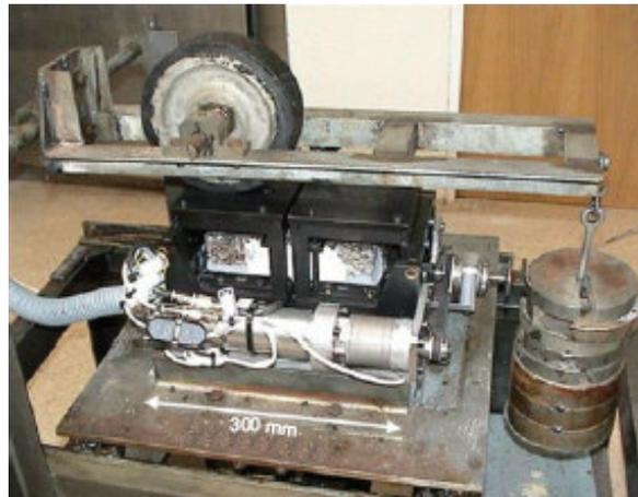
Figura 2.63 WRC instalado en máquina de ensayo de pista (Prieto *et al.*, 2007).
