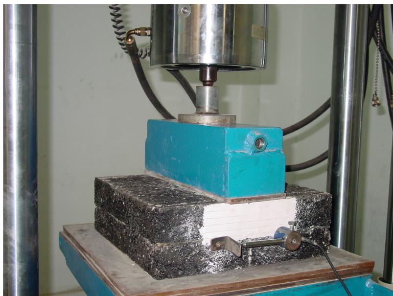
Figura 3.21 Montaje del ensayo dinámico
