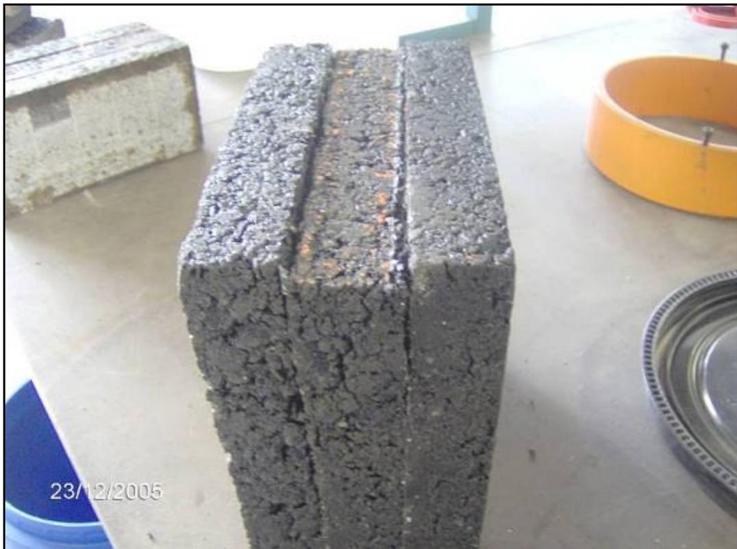
Figura 3.11 Forma de rotura en probeta completa
