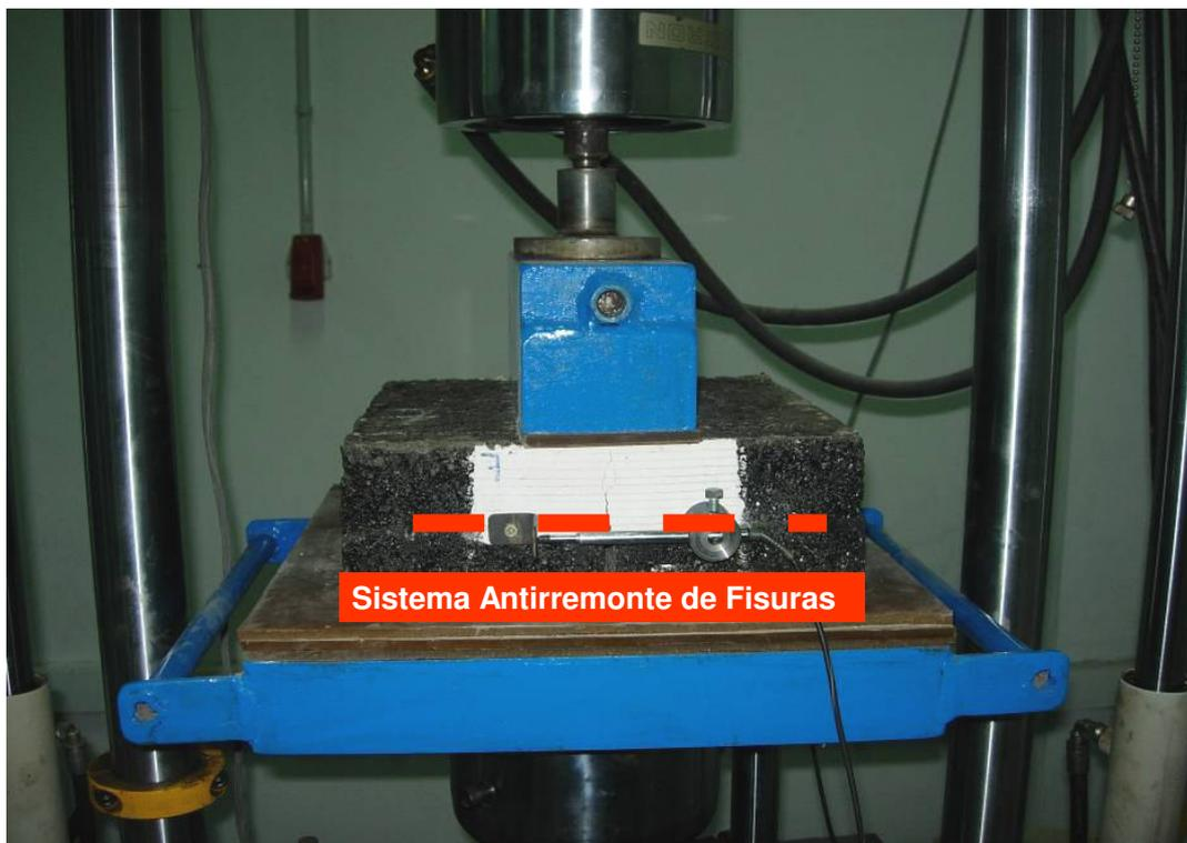
Figura 6.1 Posición del sistema antirremonte de fisuras
