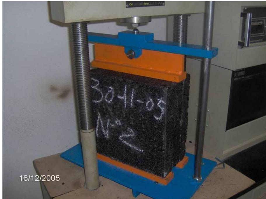
Figura 3.9 Montaje probeta, en máquina de ensayos
