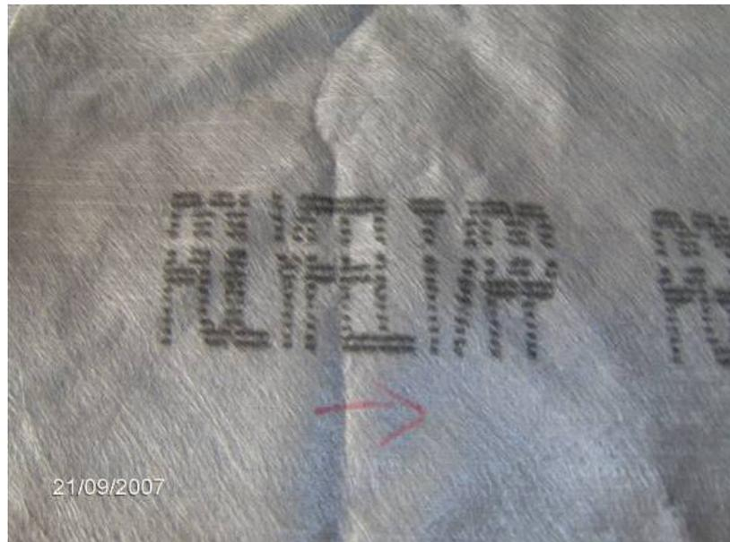
FOTO II-7 Geotextil de polipropileno (PGM-14)
