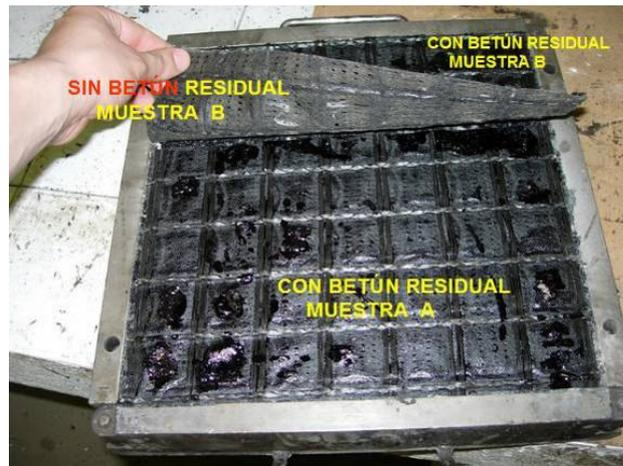
FOTO IV-22 Posición de las muestras para solape
