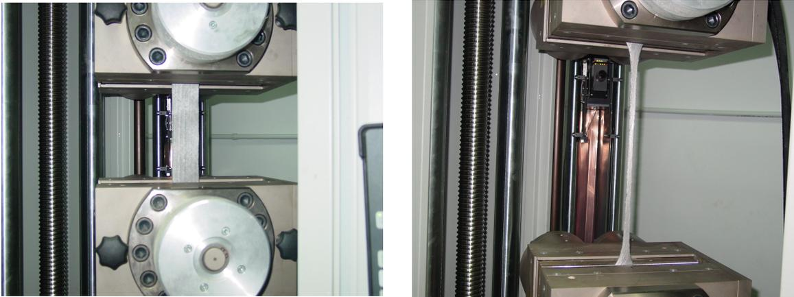
Figura 3.6 Ensayo de tracción de una probeta de geosintético
