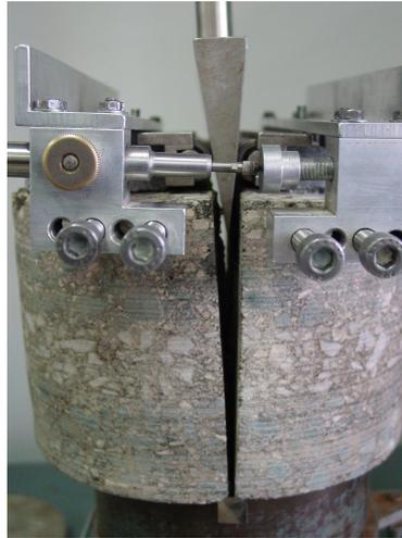
Figura 2.52 Inicio de rotura del testigo bajo la carga de la cuña
