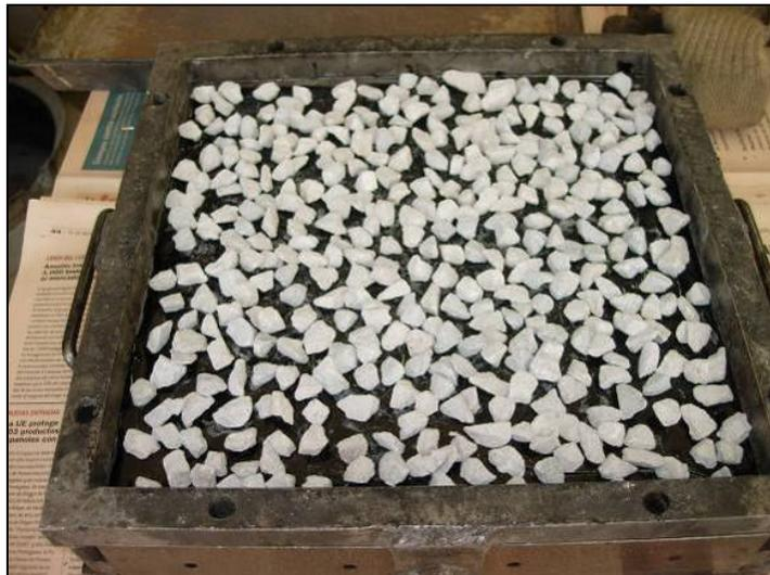
FOTO IV-19 Colocación del árido sobre el betún
