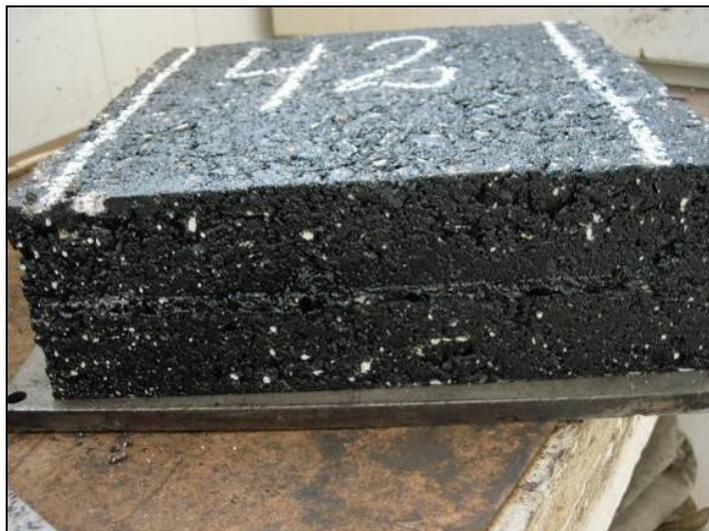
FOTO IV-20 Desmolde de probeta con SAMI
