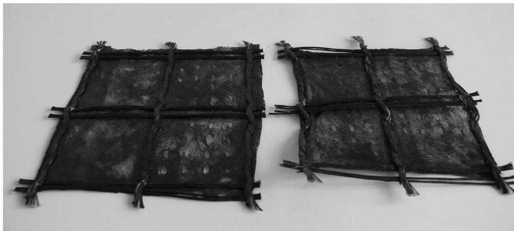
Figura 3.4 Efecto de la temperatura sobre una geomalla de poliéster ensayada a 165° C.
