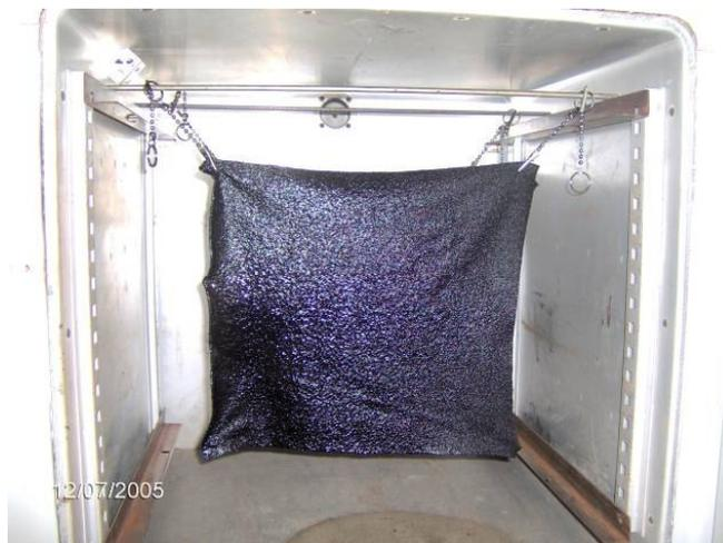
Figura 2.18 Ensayo de retención de betún en un geotextil en un horno
