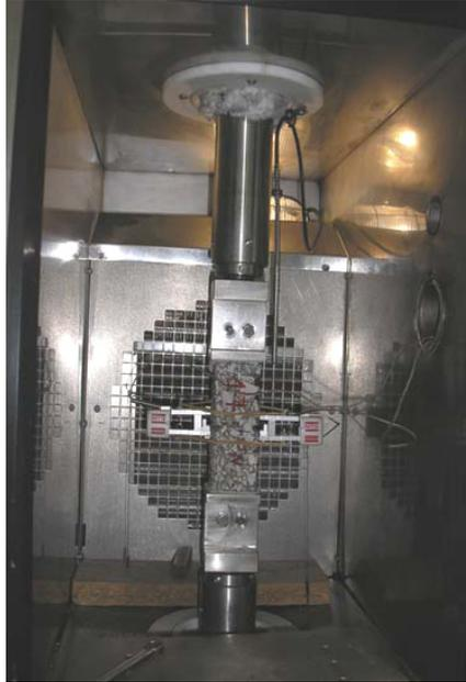
Figura 2.49 Ensayo a tracción directa de la probeta prismática, (Garrote, 2006)
