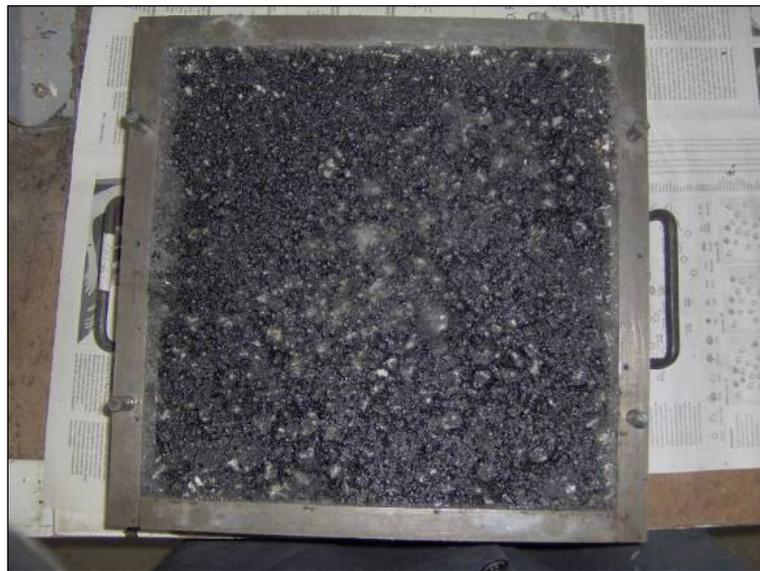
FOTO III-11 Molde de pista con mezcla
