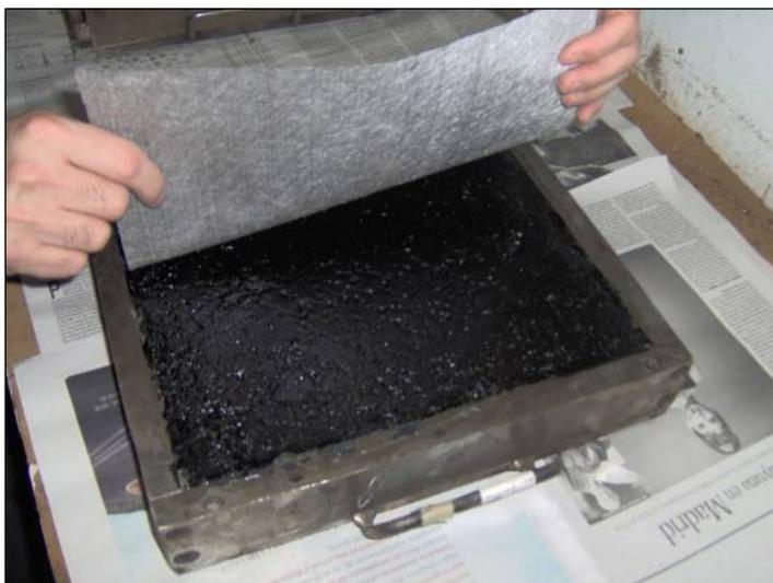
FOTO III-14 Colocación del geosintético
