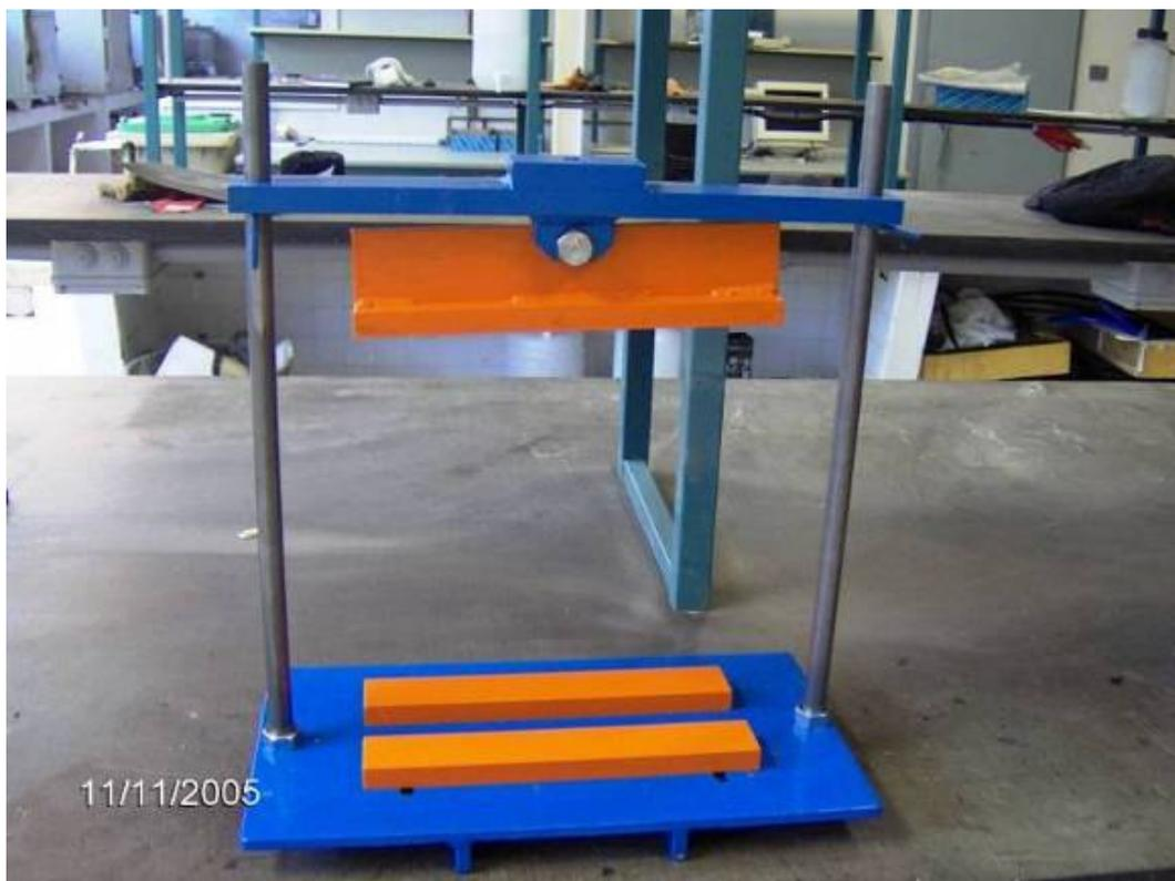
Figura 3.8 Cuna empleada en el ensayo de adherencia
