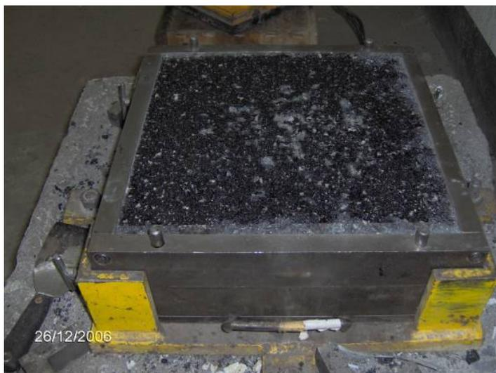
FOTO III-15 Vista del segundo molde con la mezcla compactada
