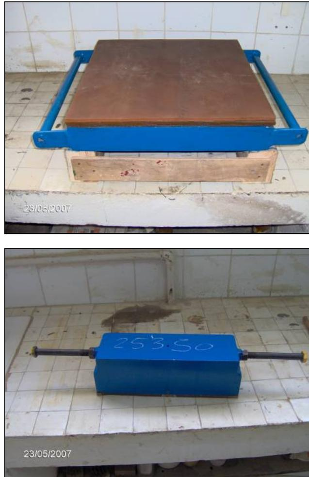
Figura 3.19 Base y elemento distribuidor de cargas
