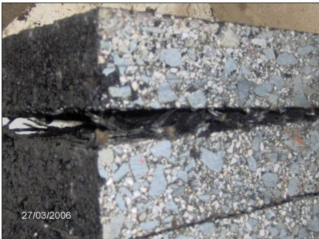
Figura 5.2 Rotura de una geomalla de poliéster con un geotextil ultraligero
