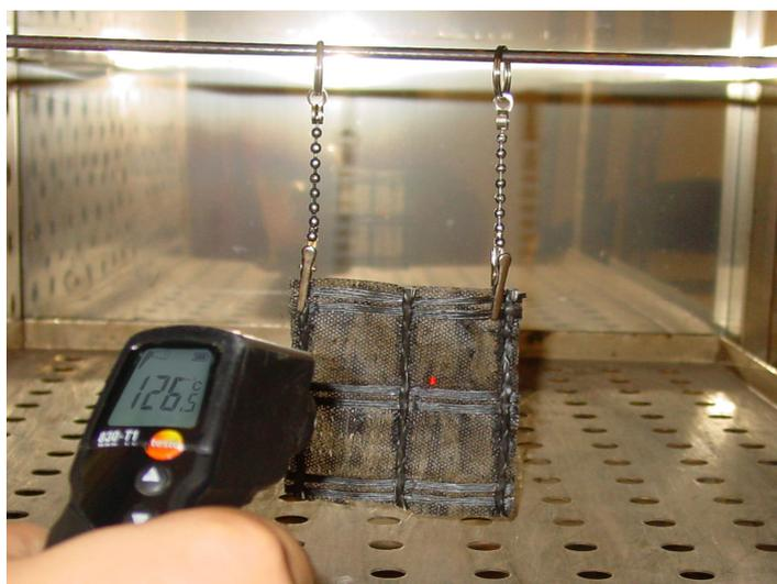
Figura 3.1 Detalle de sistema de sujeción y toma de temperatura
