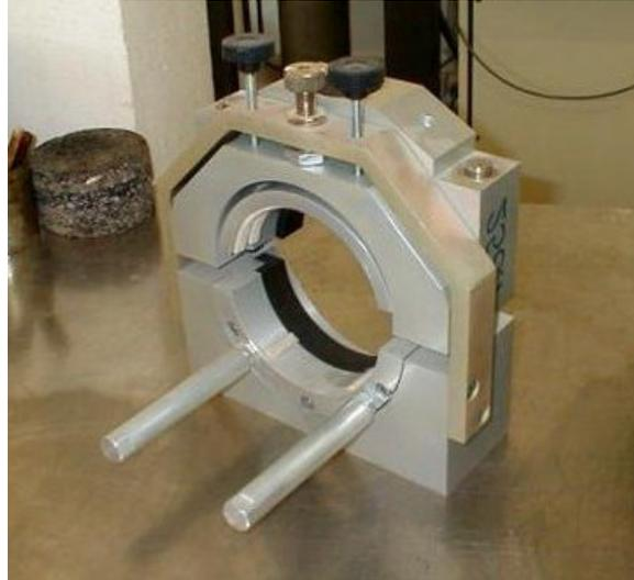
Figura 2.44 Dispositivo de mordaza utilizado en el ensayo de corte
