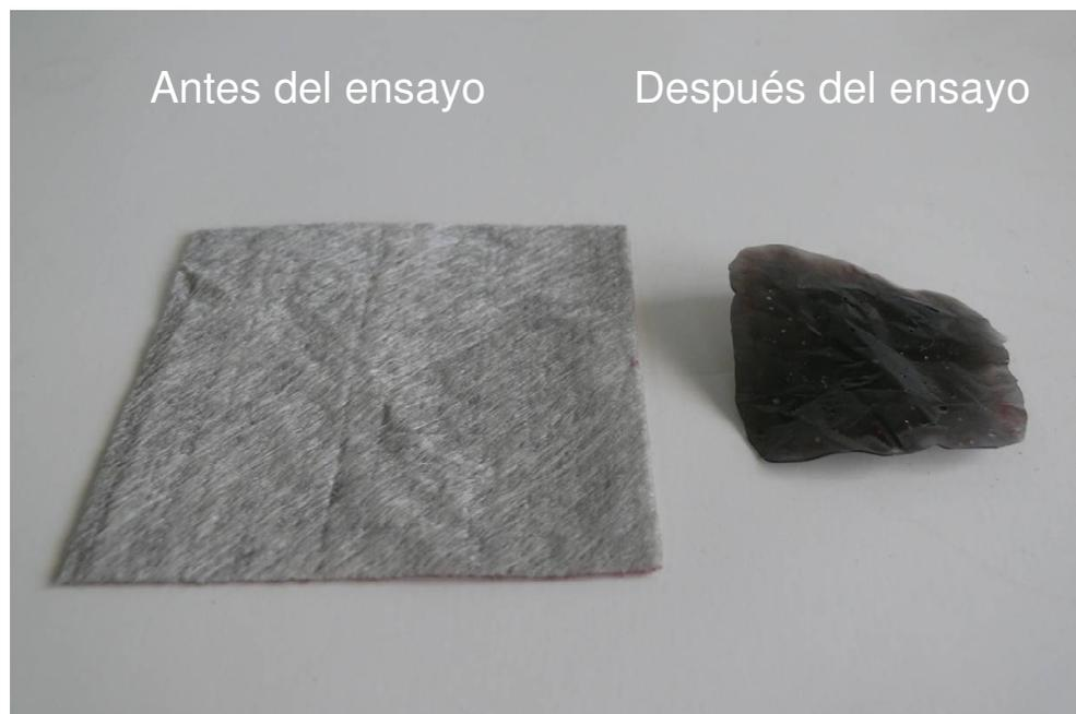
Figura 4.3 Geotextil no tejido de polipropileno probeta GT-1 a 165 °C (ensayo N° 2)
