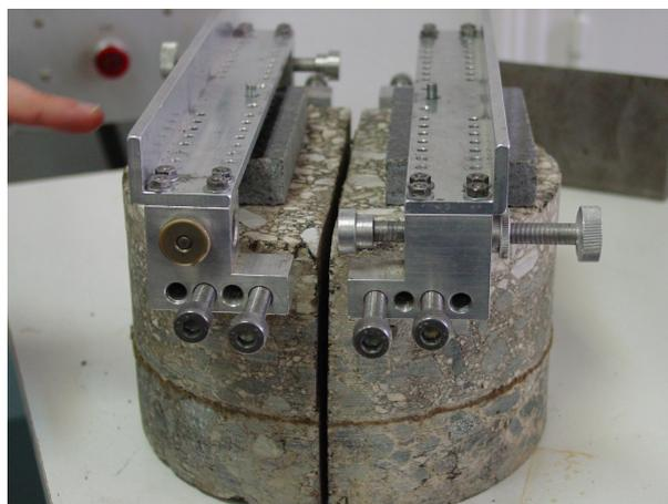
Figura 2.51 Montaje de los rodamientos sobre muestra de ensayo
