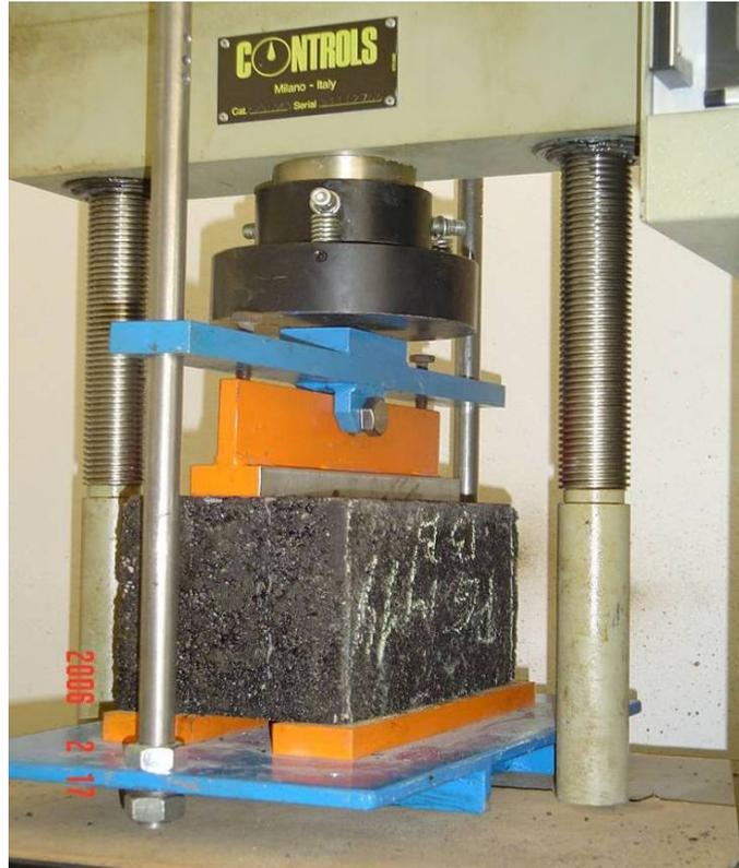
Figura 3.13 Configuración del ensayo de probeta serrada
