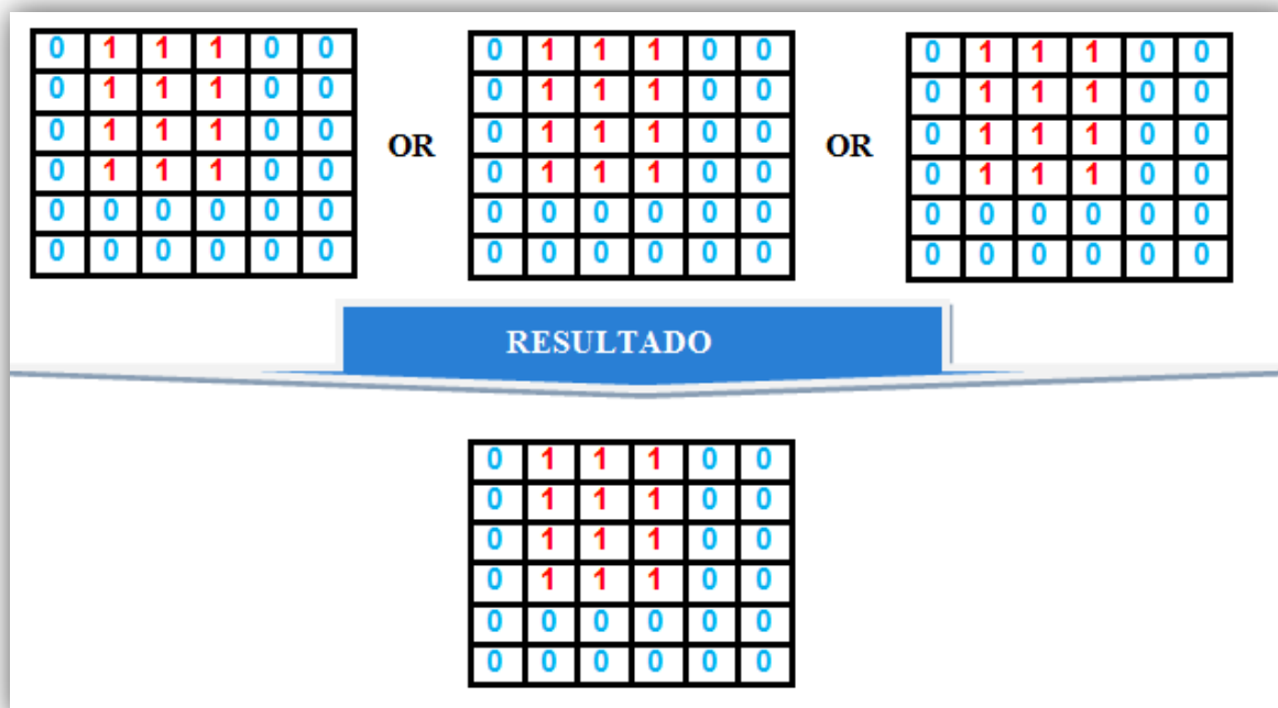
Figura 25: Operación que realiza el algoritmo tras la captura
