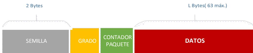
Figura 4.12 Payload de la trama de datos para la primera versión del protocolo
