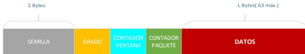
Figura 4.17 Payload de la trama de datos para la segunda versión del protocolo
