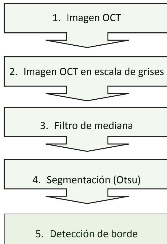
Figura 4.1 Esquema de técnica aplicada para la detección del borde superior de la muestra.
