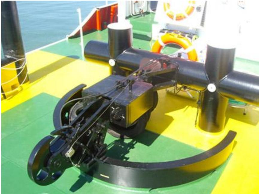
FIGURA 2.11. Gancho de remolque
