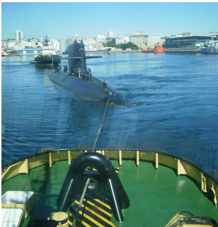
FIGURA 4.03. Maniobra de desatraque de un submarino
