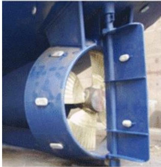
FIGURA 2.04. Hélice de paso controlable con tobera
