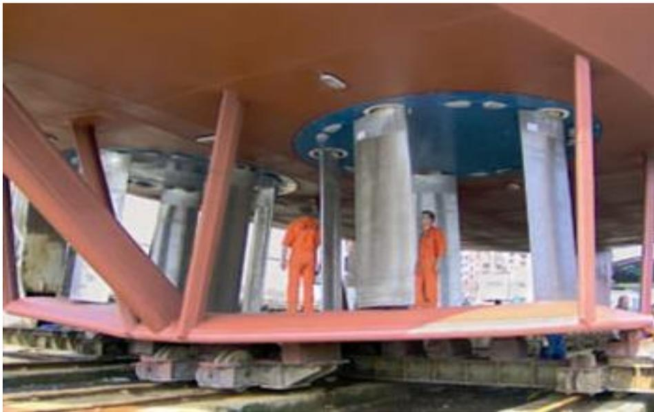
FIGURA 3.06. Instalación de un VSP en un remolcador
