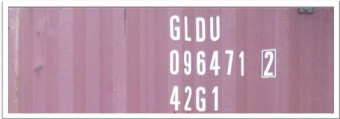
**Ilustración 14 Numeración de un contenedor. Fuente: Propia.**
