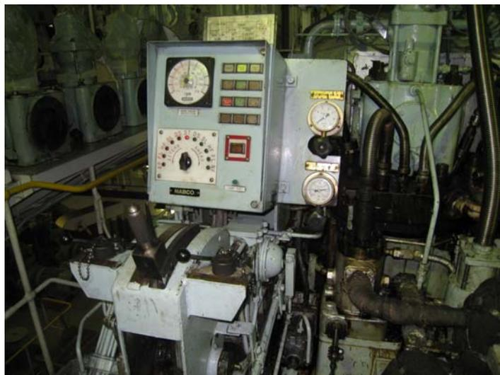
Fig.9 Puesto de control local sistema hélice de paso fijo.
