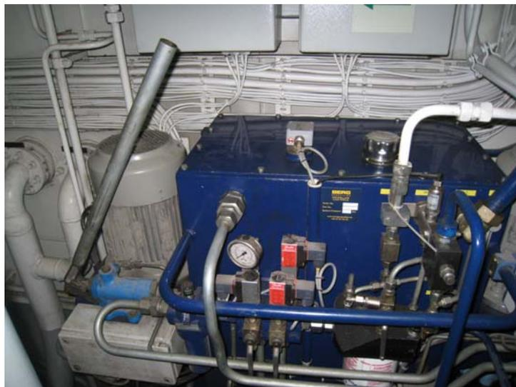
Fig.6 Central de potencia CPP con bombín manual.
