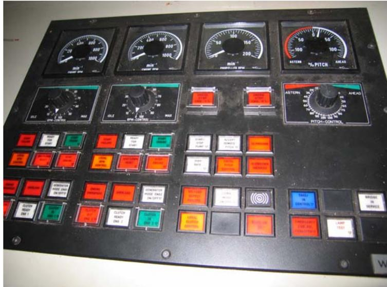
Fig.10 Control remoto CPP en cámara de máquinas.
