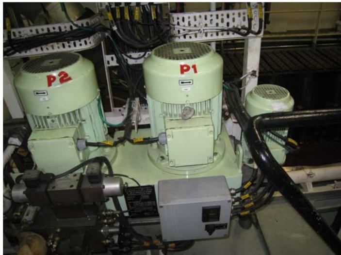
Fig.8 Puesto de control local del paso de hélice.
