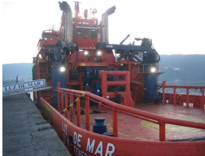
El casco está diseñado y construido con cuadernas transversales con una única cubierta corrida principal, castillo de proa con cubierta superior y cubierta castillo, caseta superior y puente.
