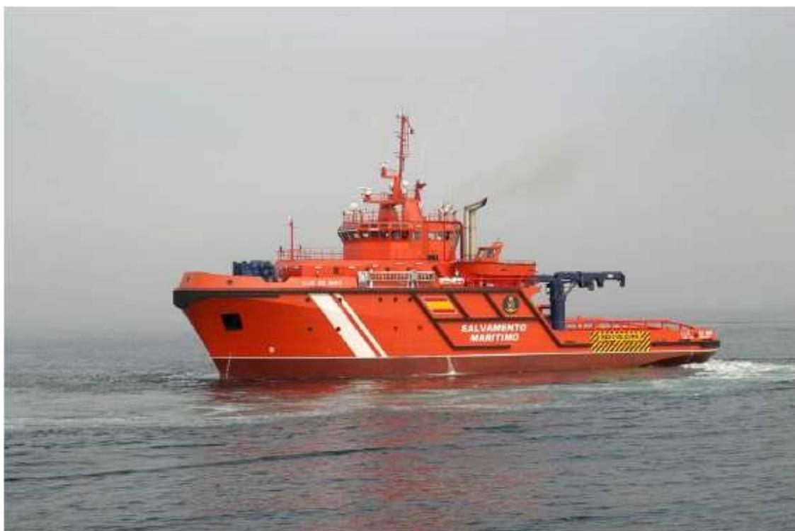
El “Luz de Mar”, cuyo presupuesto ascendió a 15 millones de euros, tiene una eslora de 56 mts., con una potencia de 10.300 CV., 124 toneladas de tiro a punto fijo sobre bolardo, capacidad de recogida de residuos de hidrocarburos y bombas de aspiración en superficie para su posterior almacenamiento y decantación en los tanques dedicados al efecto con una capacidad de hasta 293 metros cúbicos.
