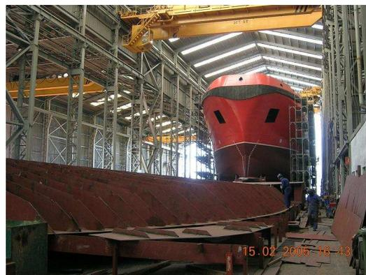
El ensamblaje de los bloques en grada se empezó montando el cuerpo de máquinas a partir del cual se ensamblaron los cuerpos de popa y proa.
