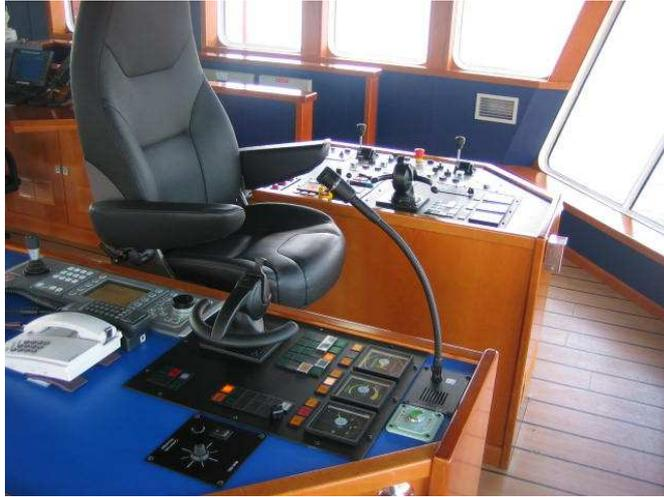
El MASTERSTICK es un sistema controlado con micro-procesador que controla el movimiento lateral y de giro, así como la magnitud de empuje.
