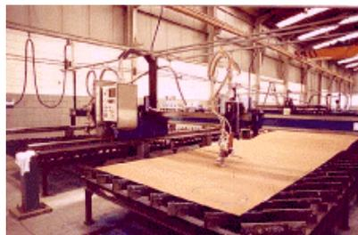
Existe una perfecta combinación del nesting automático con potentes funciones de nesting manual. Estas funciones junto con la gran velocidad del nesting permiten obtener un rendimiento óptimo en las chapas a cortar.
