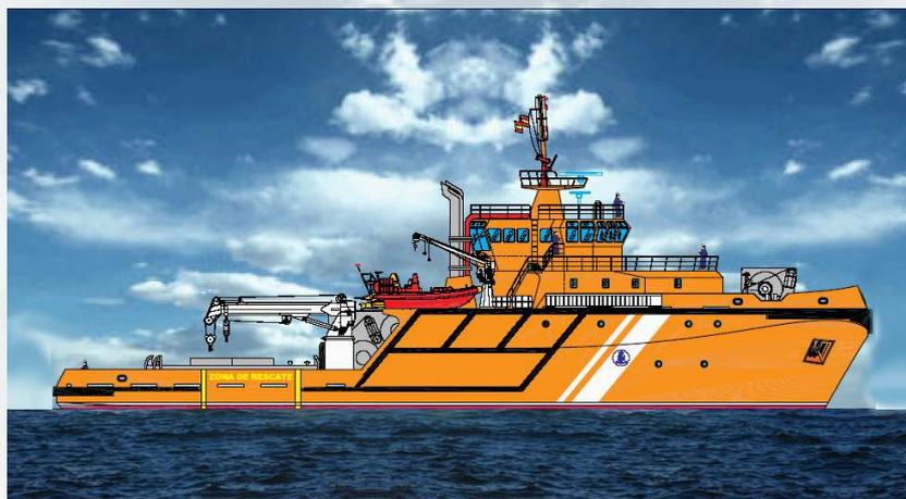
Además está diseñado para labores en puerto y terminales, operaciones de salvamento, anticontaminación y lucha contra incendios. También tiene excelentes cualidades de maniobrabilidad con propulsión y sistema de control de maniobras integrados, equipado con dos hélices azimutales. Dispone del más alto grado de seguridad, capacidad de manejo y maniobrabilidad en todas las operaciones del buque.
