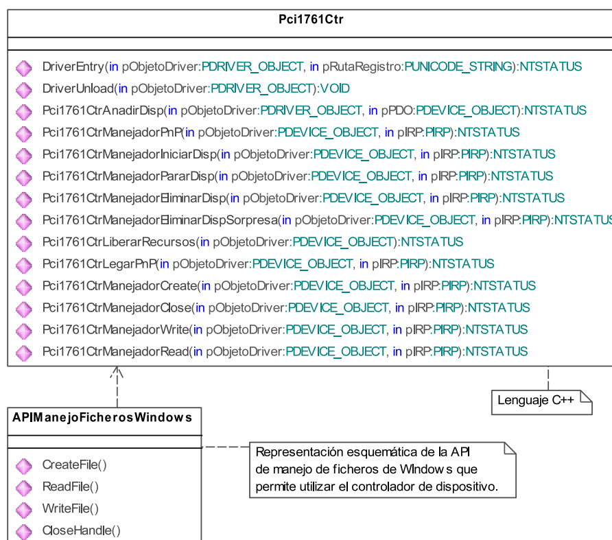
Figura 4.7: Diagrama de clases UML de la arquitectura del controlador WDM para tarjeta de E/S digitales PCI-1761.
