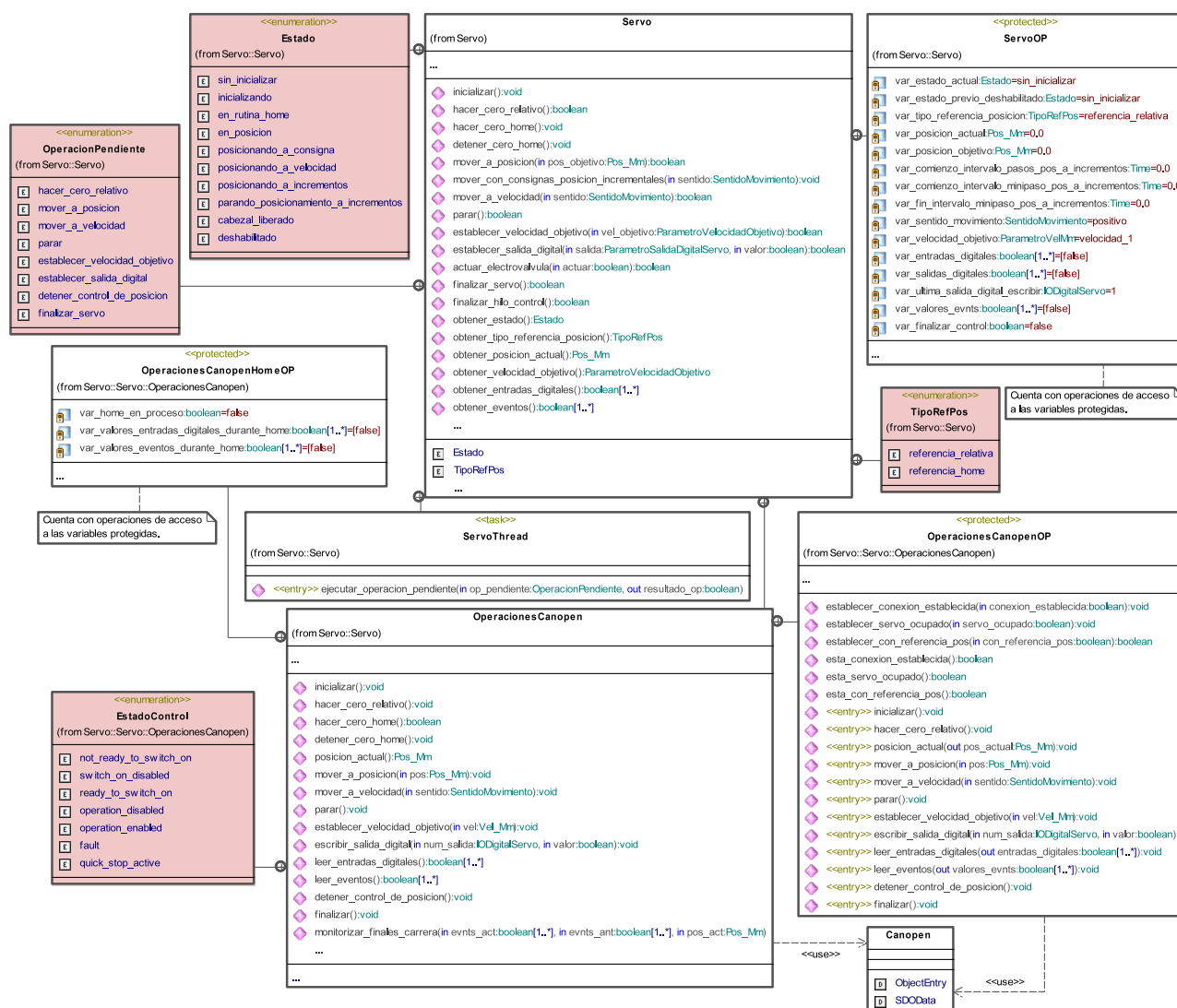
Figura 4.12: Diagrama de clases UML de los módulos relacionados con el servo en el software de Mármol. Algunos detalles como operaciones o clases privadas han sido omitidos por razones de espacio.
