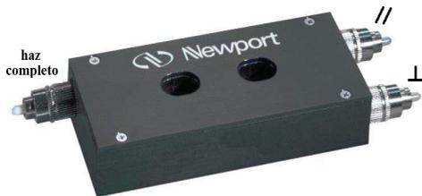
El PBS (del ingles *Polarization Beam Splitter*, divisor de polarizaciones) F-PBC- 15-SM-FA de Newport es un dispositivo que permite separar la luz entrante por uno de sus puertos en las dos polarizaciones paralela y ortogonal, las cuales salen por los otros dos puertos.
