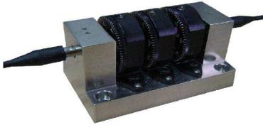
El controlador de polarización (Thorlabs FBROS) es un dispositivo capaz de cambiar la polarización de la luz entrante a cualquier otra que se desee. Consta de 3 laminas retardadoras: dos en los extremos de un cuarto de longitud de onda ( $\lambda/4$ ) y una central de media longitud de onda ( $\lambda/2$ ).
