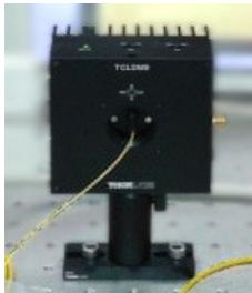
Esta montura, modelo TCLDM9 de Thorlabs, (foto a la izquierda) permite acoplar láseres de semiconductor (no solo VCSELs) de forma rápida, fijándose en la correcta colocación de los contactos. Pueden acoplarse láseres con carcasa de 5.6 ó 9 mm indistintamente, láseres acoplados a fibra como es el caso, o láseres que emiten al aire. Esta montura permite controlar la temperatura del VCSEL utilizando el efecto Peltier mediante el uso de dos laminas refrigeradoras
