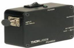
El fotodetector es un dispositivo que proporciona una intensidad o voltaje en respuesta a la potencia óptica incidente sobre la superficie sensora de radiación óptica. El utilizado en este trabajo es el PDA8GS de Thorlabs, con entrada de fibra óptica, ancho de banda de 8 GHz y responsividad 0.9 A/W a 1550 nm. El fotodetector, en este caso, esta conectado al analizador de espectros de radiofrecuencia, que describimos a continuación.
