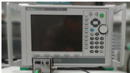
El analizador de espectros de radiofrecuencia (RF) ANRITSU MS2719B mide básicamente la potencia en dBm en función de la frecuencia de la señal proveniente del fotodetector, el cual recoge la radiación óptica. Opera en el rango de frecuencias de 9 kHz a 20 GHz, con la posibilidad de ajustar el intervalo de medida.
