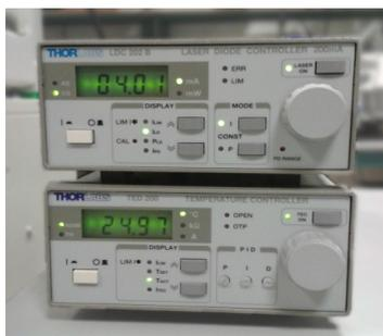
En la parte superior se muestra el controlador de corriente para VCSELs LDC205C. La intensidad de corriente que pasa por el VCSEL puede variarse entre 0 y 20 mA con una precisión de 0.001 mA. En la parte inferior de la figura de la izquierda se muestra el controlador de temperatura para láseres de semiconductor TED200, regulado a la temperatura que se mantuvo durante todo el trabajo de investigación (25°C). El controlador de temperatura tiene una precisión de 0.01°C.
