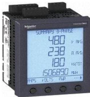
Para la monitorización de los sistemas generadores se ha optado por la instalación del PM820. Es una central de medida capaz de medir con una precisión excepcional altas cargas no lineales.
