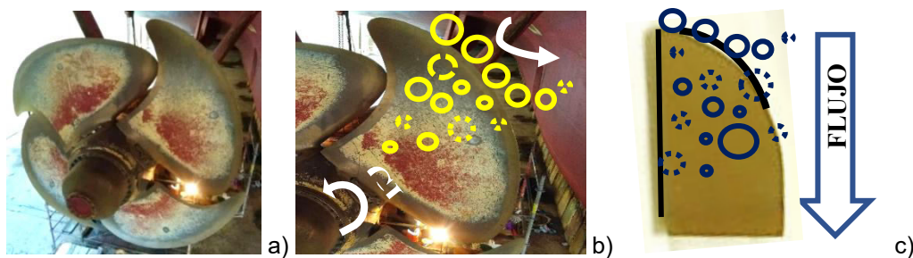
Figura 30. a) Hélice de un carguero. b) Pala de la hélice. c) Probeta 16 x 23 x 3 mm para ensayo de cavitación. Fuente: Propia
