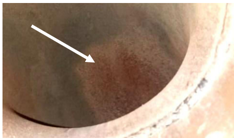
Figura 11. Corrosión por erosión en tubería de acero al carbono. Fuente: Propia
