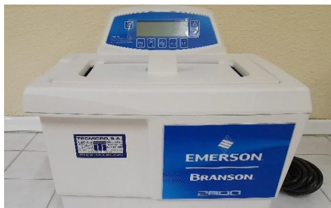
Figura 34. Baño de Ultrasonidos Emerson Branson 2800. Fuente: Propia
