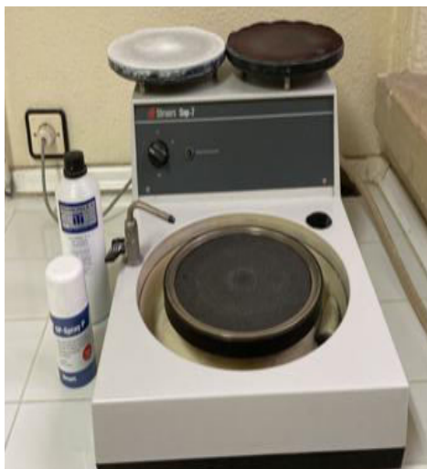
Figura 32. Pulidora manual Struers Dap-7. Se observan los discos utilizados, la pasta de alúmina y el spray de diamante. Fuente: Propia
