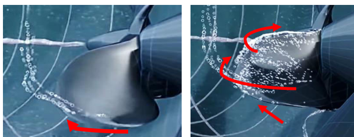
Figura 29. Simulación del flujo de la hélice naval en dos instantes de tiempo tras el giro [246].
