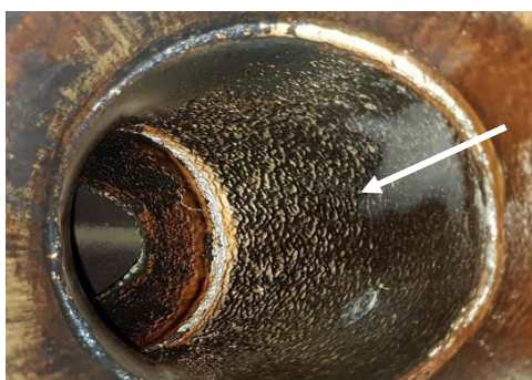
Figura 12. Corrosión cavitación en tubería de acero al carbono. Fuente: Propia.
