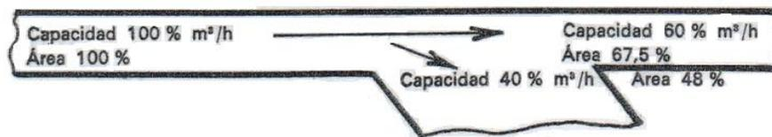
Figura 2. Porcentaje de área de sección recta en ramas para conservar constante el rozamiento.
