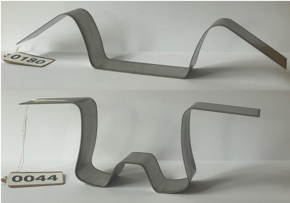
Figura 4.3.7: Probetas tipo U y tipo W tras su extracción del útil, mostrando su estado final después del proceso de conformado, junto con las etiquetas empleadas para su trazabilidad
