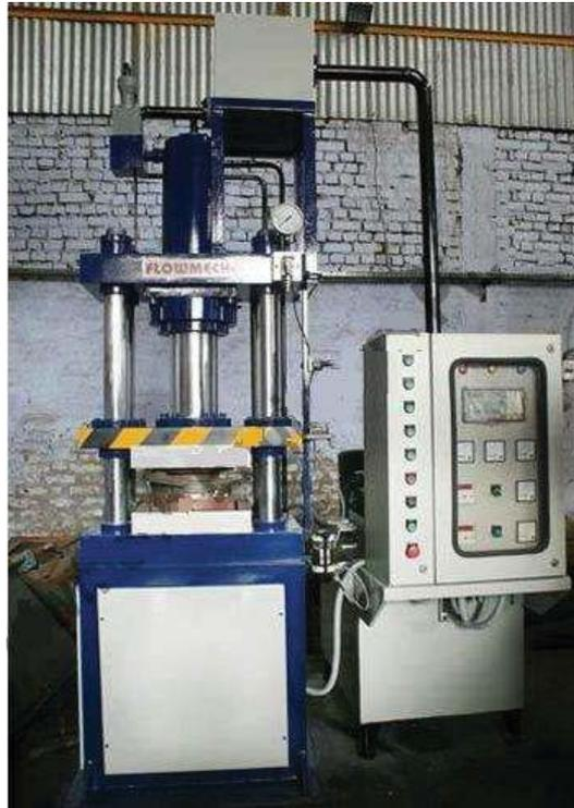
**Figura 19.** *Detalle de una prensa de moldeo por transferencia*
