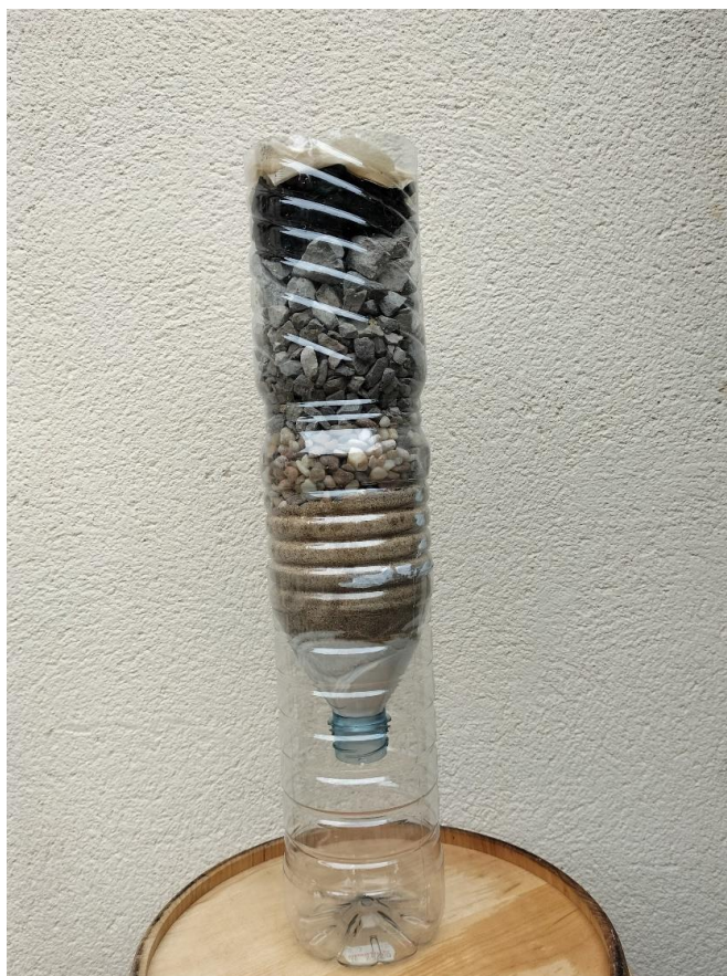
Imagen nº 3: Disposición de los materiales dentro del filtro
