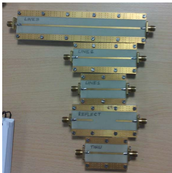
Figura IV.1. TRL utilizado para la calibración del analizador de redes.
