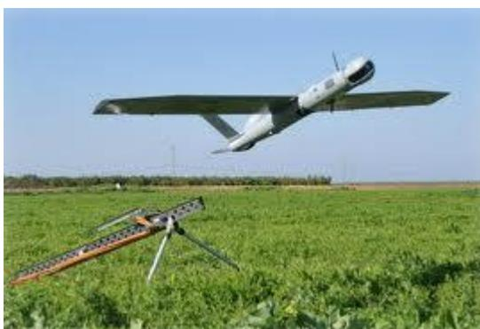
Figura 4.4: UAV de ala fija de despegue por lanzadera.
