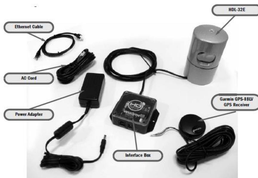
Figura 6.8: Kit de conexiones del LIDAR HDL-32E de Velodyne.
