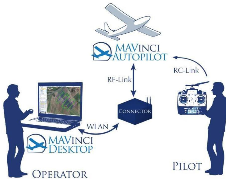
**Figura 7.5: Esquema funcional del sistema MAVinci.**
