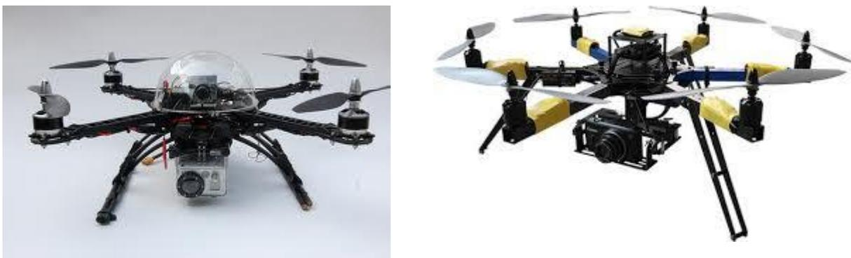
**Figura 4.7: Quadcopter y hexacopter UAV.**
