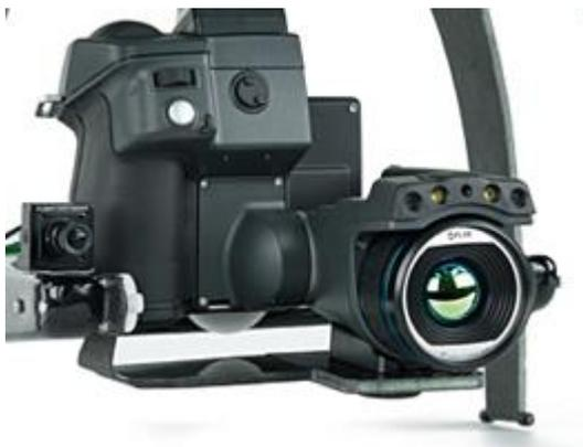
Figura 6.13: Cámara térmica de la serie T de Flir T640.
