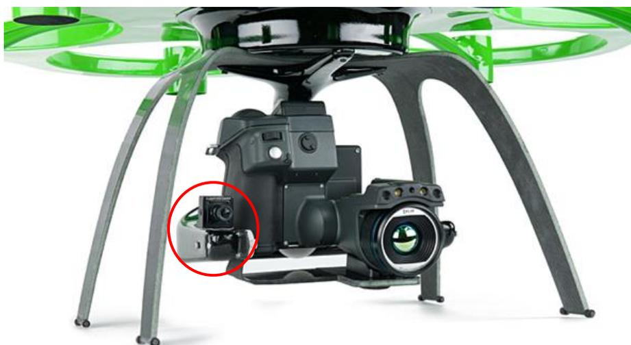
**Figura 4.9:** Hexacóptero Aibotix 6 montado con una cámara termográfica T640 de Flir y micro cámara SMART con DSP.
