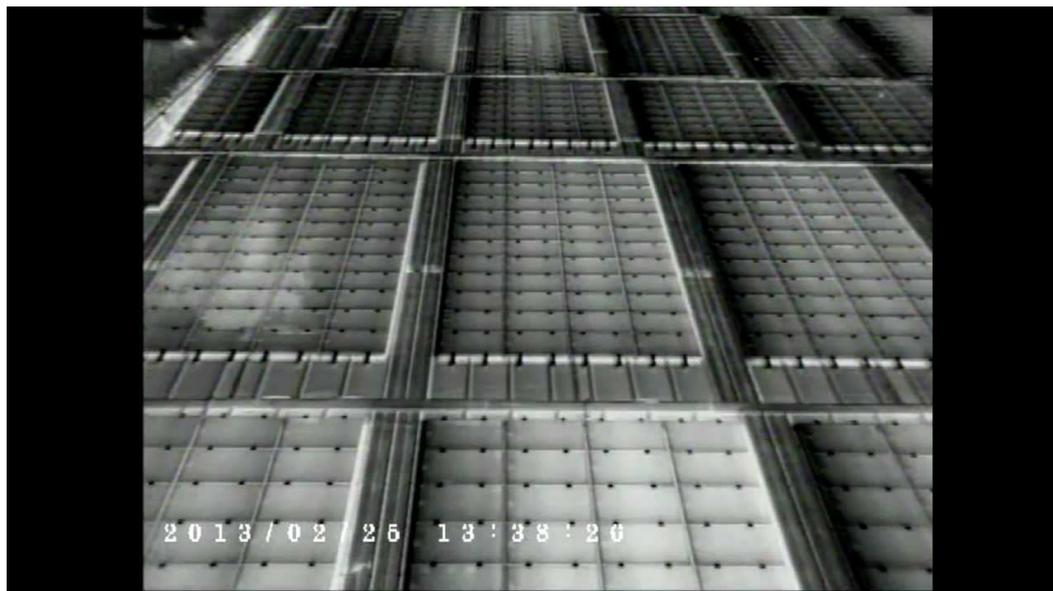
**Figura 8.1: Imagen termográfica de una planta fotovoltaica.**
