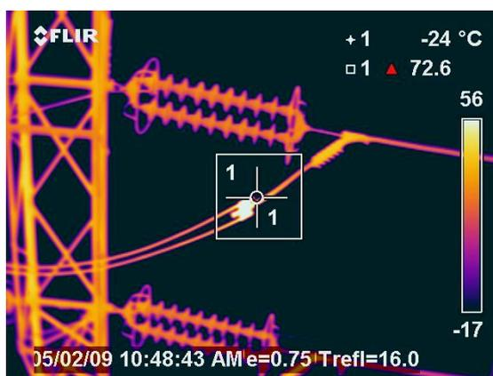
Figura 8.4: Termografía aérea en líneas eléctricas mediante cámara térmica Flir.
