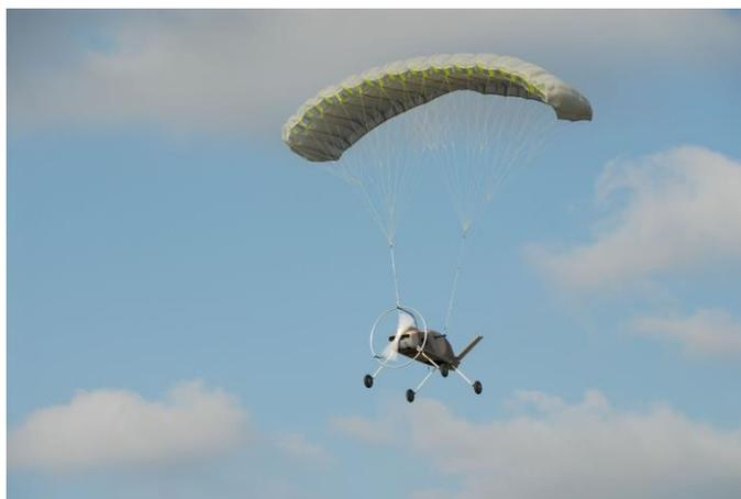
Figura 4.5: UAV de despegue no vertical de ala flexible.
