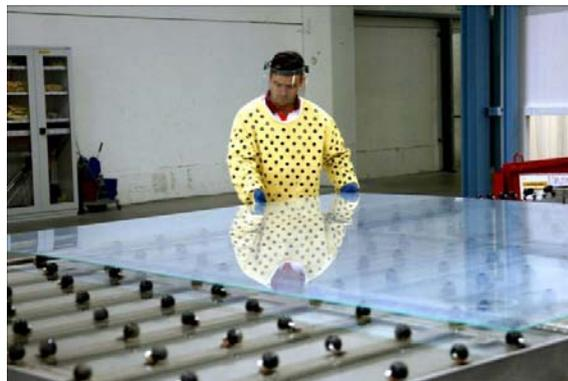
Figura 2.5. Fabricación de un módulo FV por T-Solar (Fuente T-Solar)
