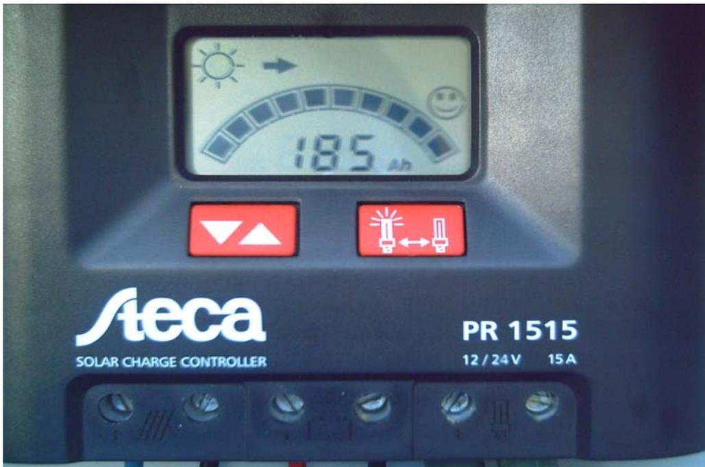
Figura 5.1. Visualización del histórico de energía generada en la pantalla del regulador
