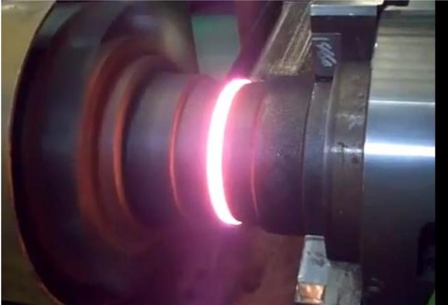
Ilustración 1 Ejemplo de proceso para soldadura por fricción
