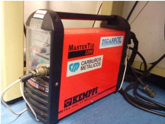
Ilustración 39 Fuente de alimentación Mastertig 2200 de Kempfi
