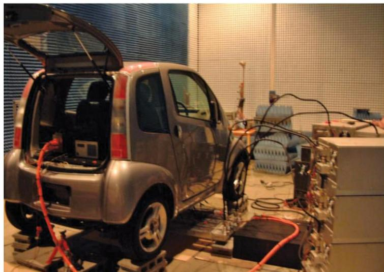
Figura 2.6. Experimentos de recarga inalámbrica con microondas realizados en la Universidad de Kioto [19].
