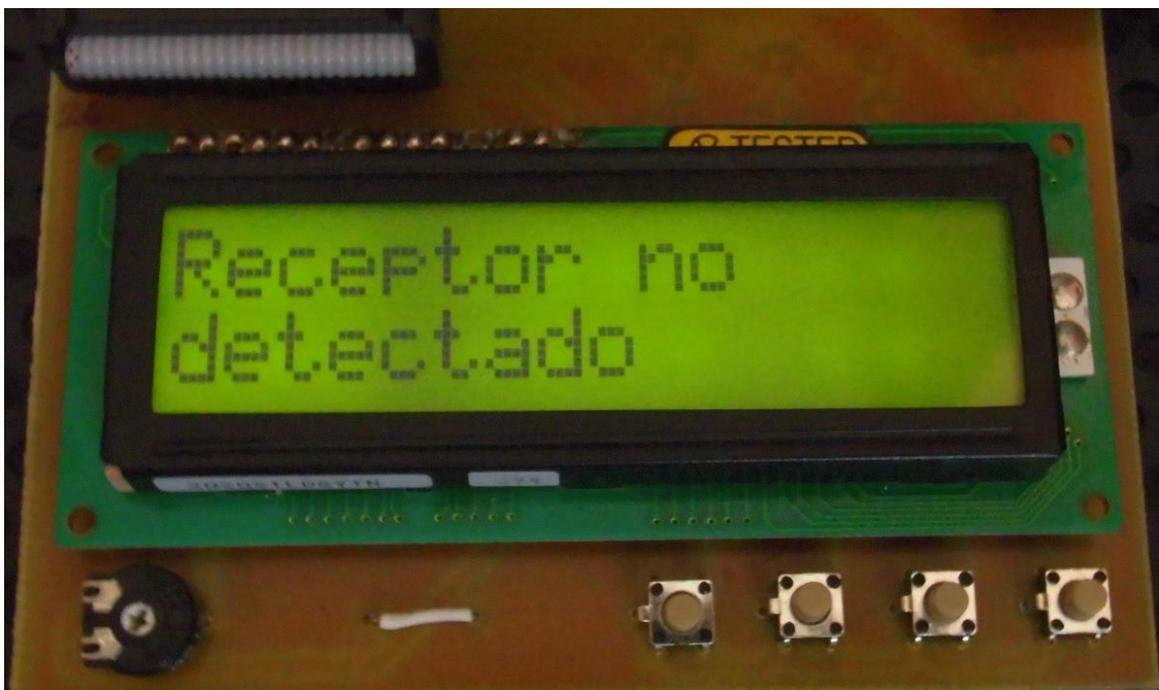
Figura 40 - Mensaje de error en la LCD cuando no está conectado el receptor
