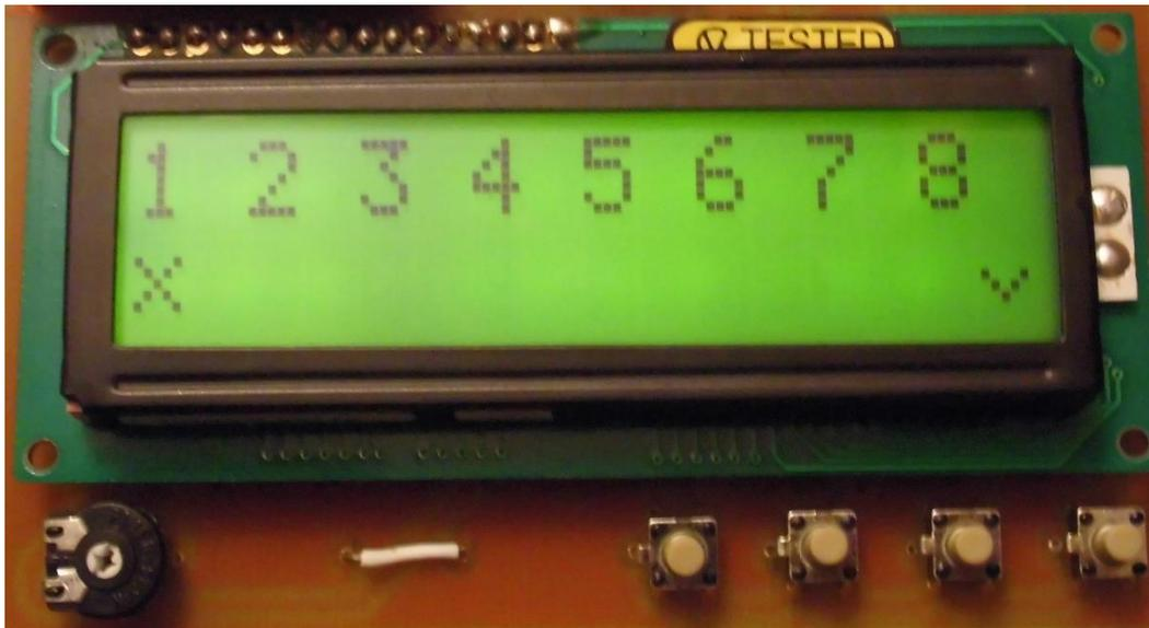
Figura 35 - LCD mostrando una respuesta invalida para el clicker 1
