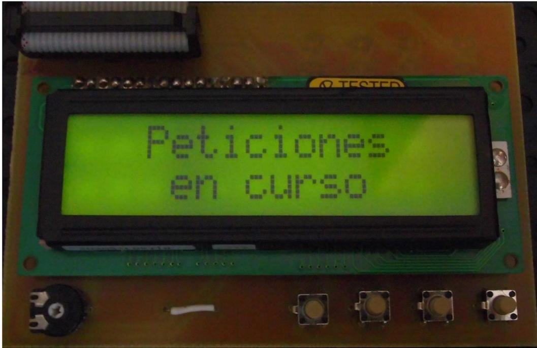
Figura 41 - Mensaje de error en la LCD al intentar reiniciar o salir de la escucha mientras hay peticiones pendientes
