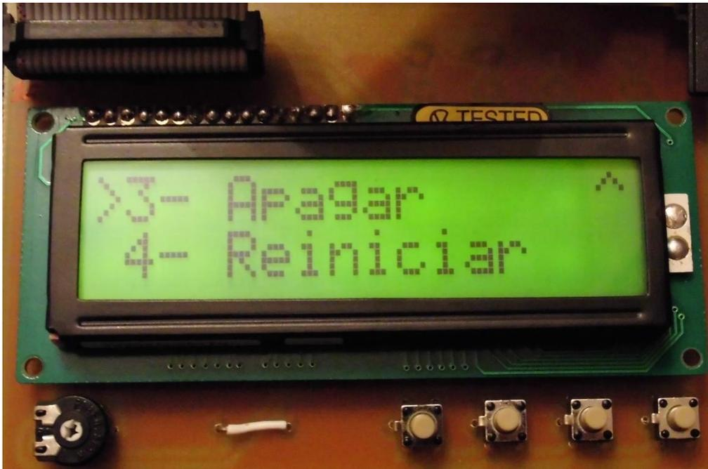
Figura 71 - Opciones de apagar y reiniciar la Raspberry Pi en el menú
