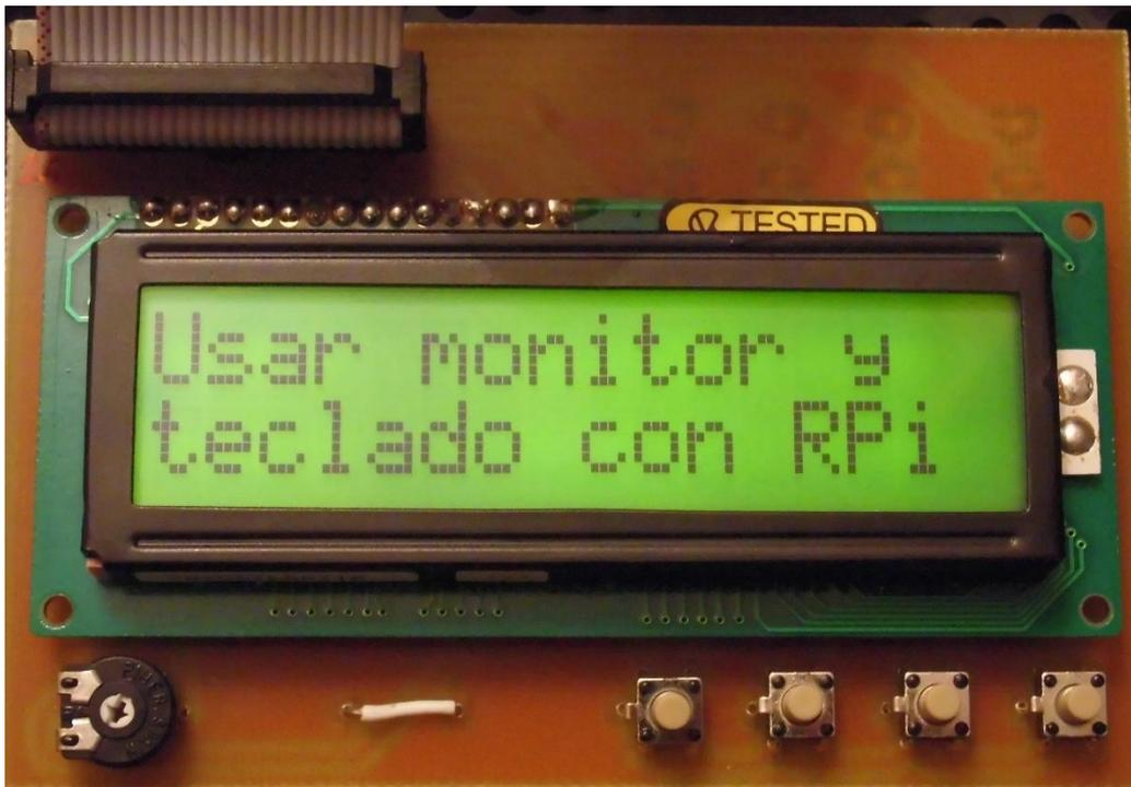
Figura 26 - Pantalla de aviso durante la configuración con monitor y teclado
