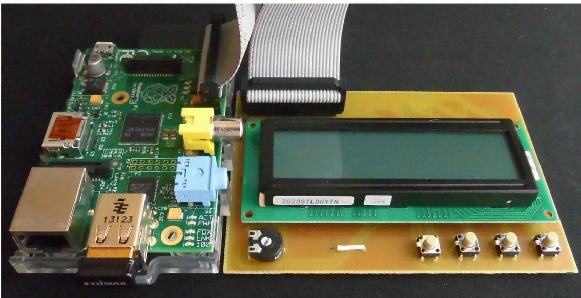
Figura 15 - Raspberry Pi conectada a la placa de control
