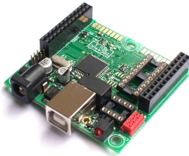
Figura 7. Tarjeta basada en microcontrolador PIC, SBC44UC
