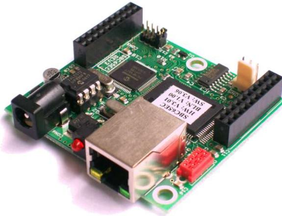
Figura 8. Tarjeta basada en microcontrolador PIC, con conexión Ethernet, SBC65EC
